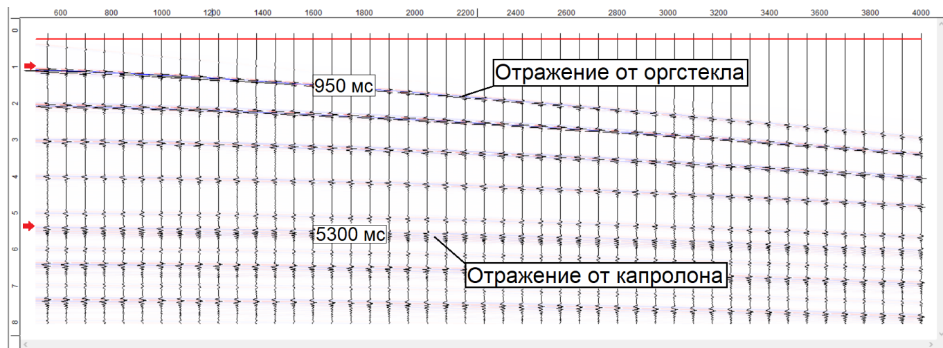
Рис. 20: Модель 2. Расчёт времен прихода отражений от кровли оргстеклянной пластины и капролонового блока в программе Tesselal.
