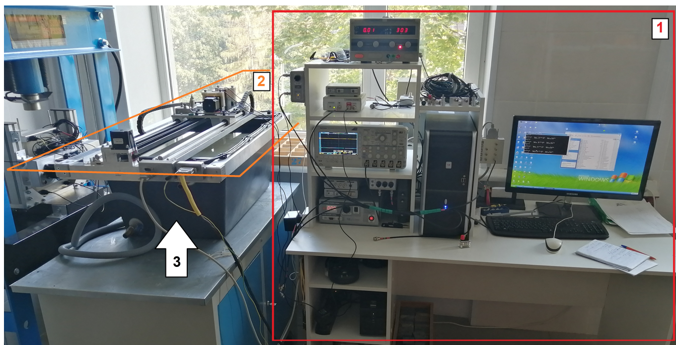
Рис. 9: Элементы установки физического моделирования: 1 – аппаратный комплекс; 2 – система позиционирования и пьезокерамические преобразователи, 3 – бак с моделью.
