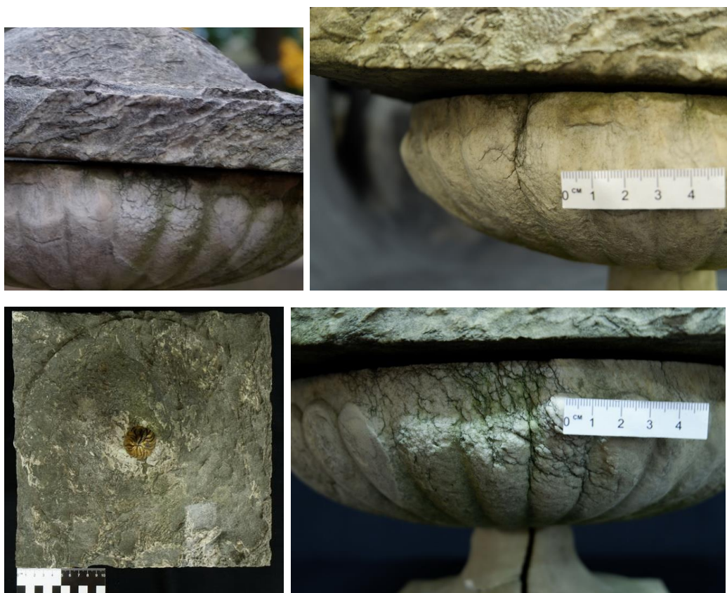
Рис. 2. Налет водорослей, колонии темноокрашенных грибов, грязевые наслоения на мраморе.
