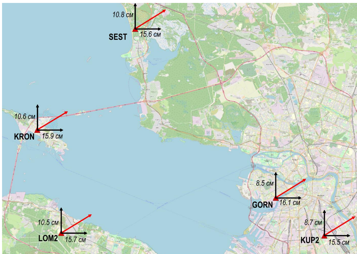
Рис.18. Схема расположения исследуемых станций и их перемещения, метод PPP
