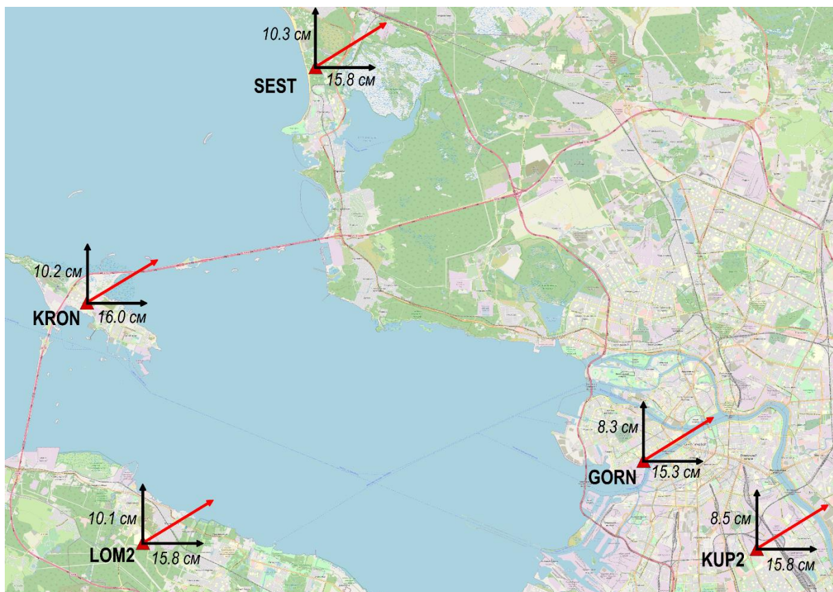
Рис.22. Схема расположения исследуемых станций и их перемещения, относительный способ
