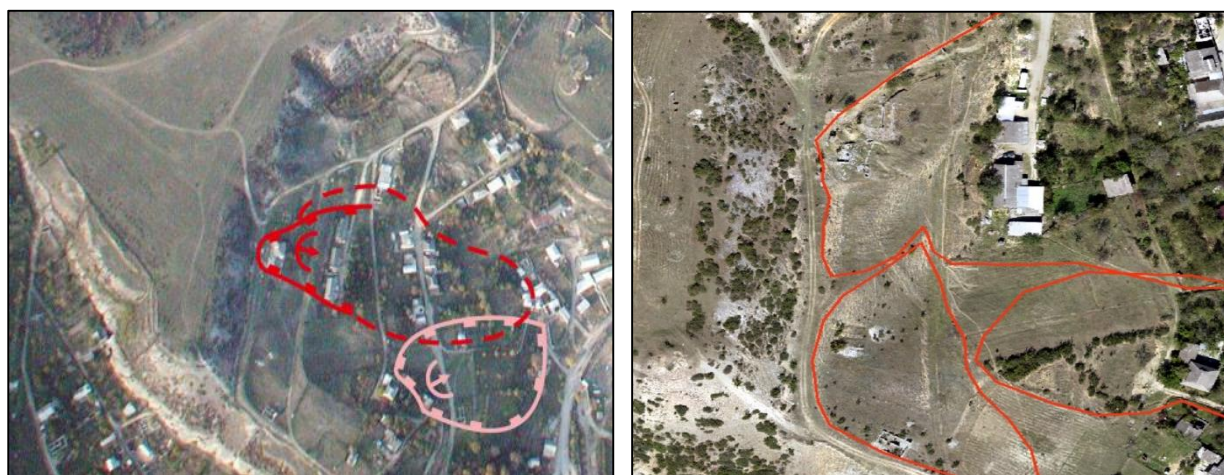
Рисунки 30 а, б. Поверхности отрыва масс пород в районе Беловецкой горки по данным генерального плана в 2013 году и современные поверхности отрыва масс пород, выявленные по результатам мониторинга
