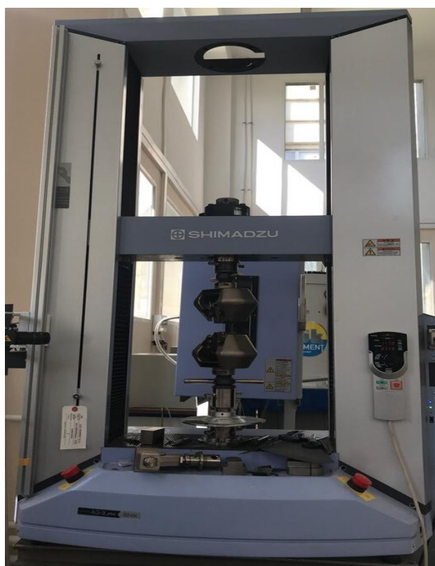
Рисунок 7. Испытательная машина SHIMADZU AG-X 50kN
