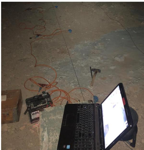
*Рисунок 48 Сейсмическая коса с геофонами*
