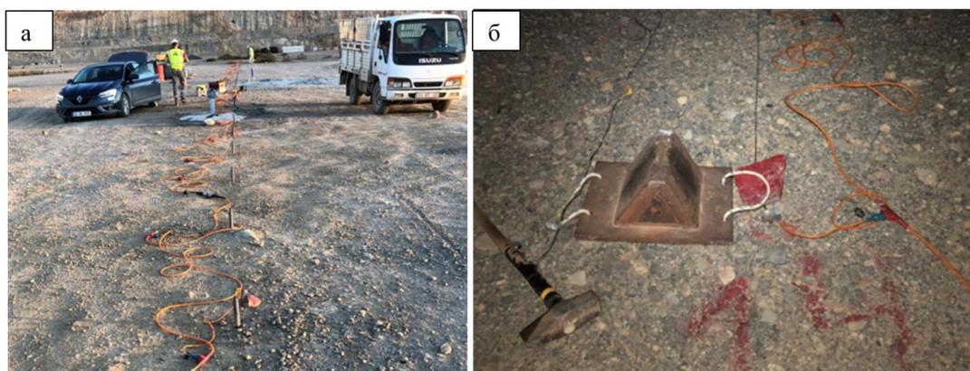
*Рисунок 25 Сейсмическая коса с геофонами: а - для регистрации Р-волн; б – для регистрации S-волн*
