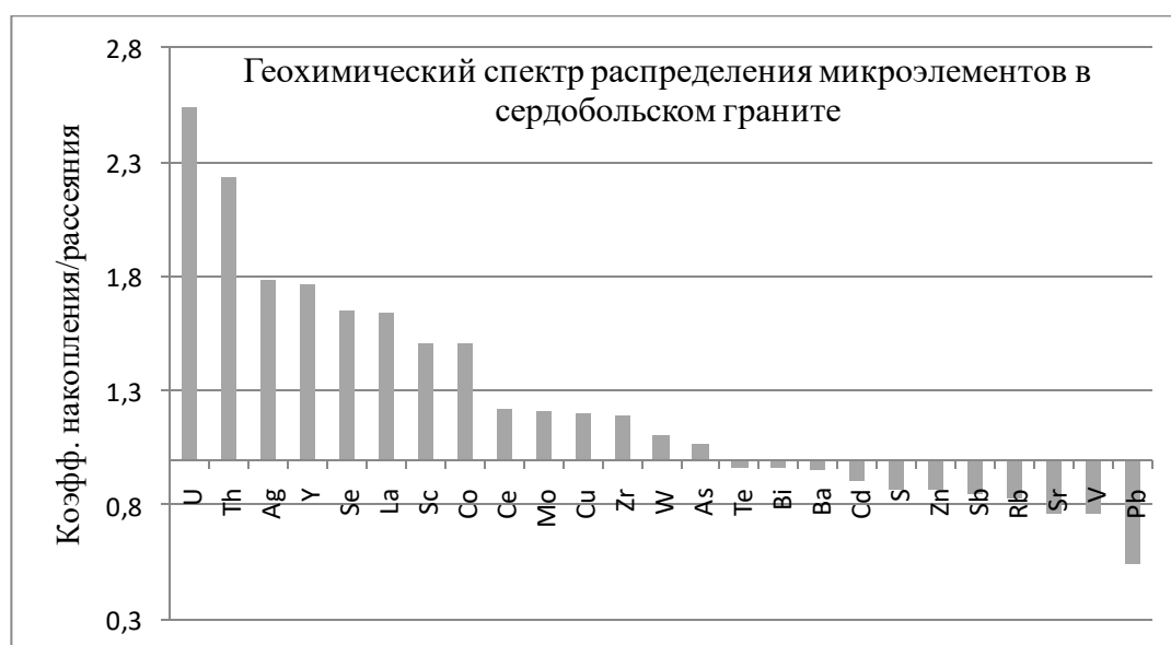
Рис. 51. Геохимический спектр распределения микроэлементов в сердобольском граните.
