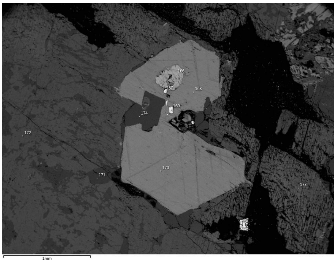
Рис. 40. Изображение гранита рапакиви, полученное методом СЭМ, где 166 – ильменит, 167, 169 – циркон, 168, 170 – биотит, 171, 174 – кварц, 172, 173 – КПШ.
