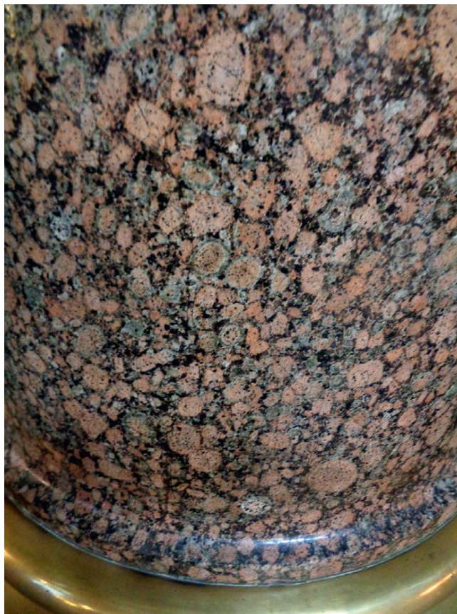
Рис. 10. Гранит рапакиви (выборгит) в колонне внутри Казанского собора (Булах и др., 2016).
