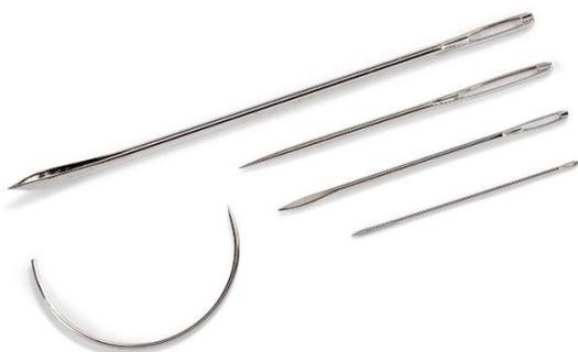
прямые двухконечные и т.д.: кривая игла и игла с двумя остриями используются для прошивки различных обивочных материалов. Кривой иглой пришивают пружины к лентам и мешковине, игла с двумя остриями
