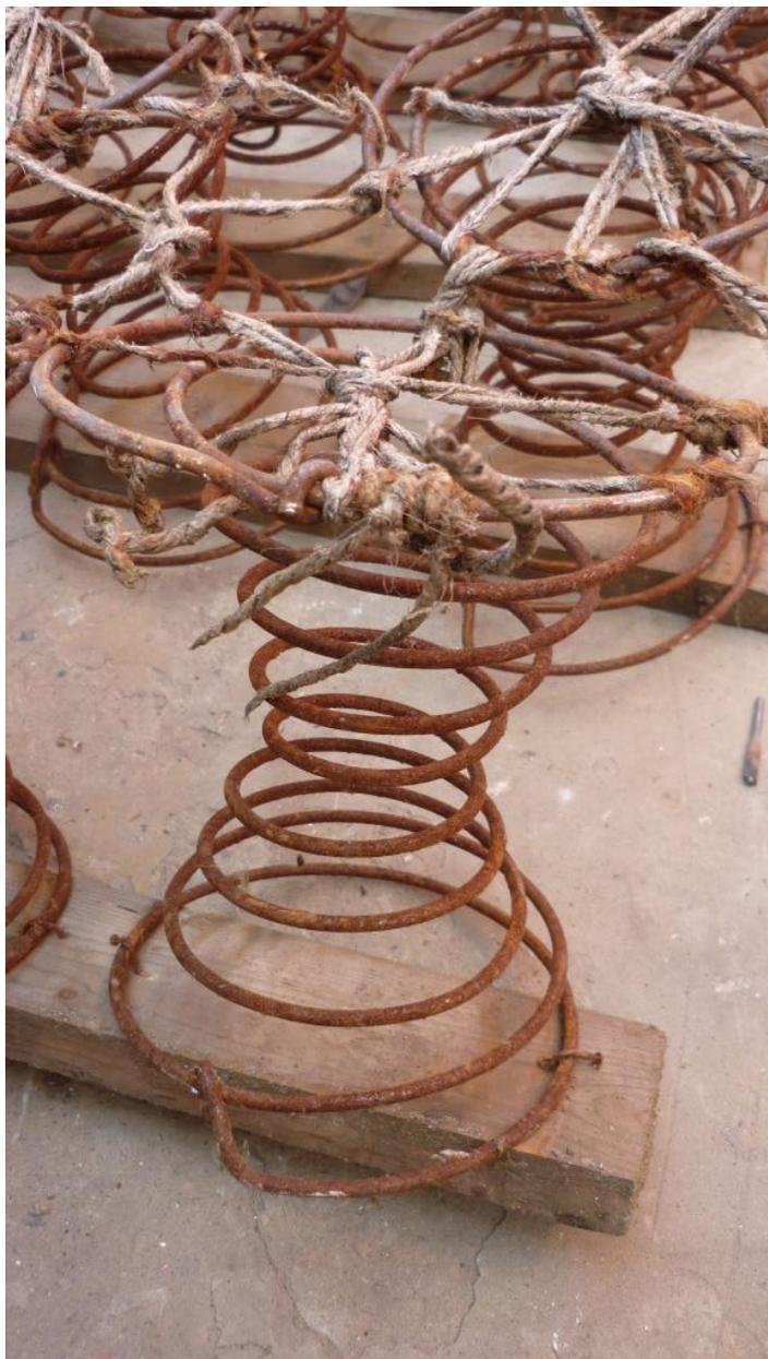
Пружины в XIX веке были в основной массе своей одно- и двухконусными, изготовленными из проволоки диаметром 3, 3,5 и 4 мм с
