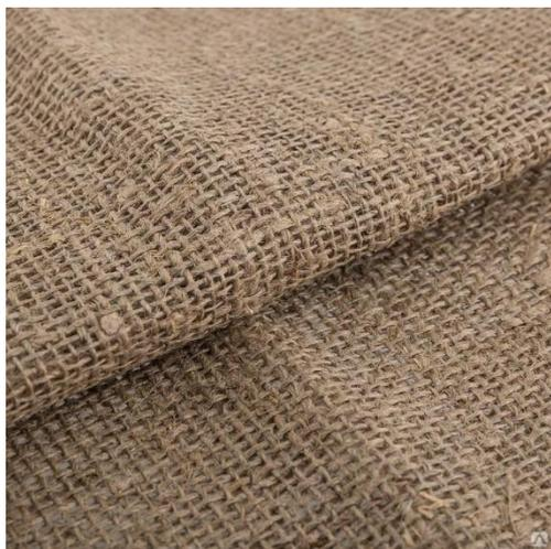
**Мешковина** – грубая ткань, изготавливалась из джутовой или пеньковой пряжи. В мебельном деле использовалась для покрытия пружин, пошивки бортов и черновой заготовки; бывает разного веса – от 200 до 400 г. Самую прочную и
