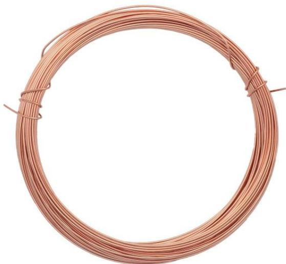
**Проволока** в производстве мягкой мебели используется толщиной 1,8 – 2,2 мм (для проволочной сетки в рамке сиденья дивана, кушетки, оттоманки, матраца и проч.).
