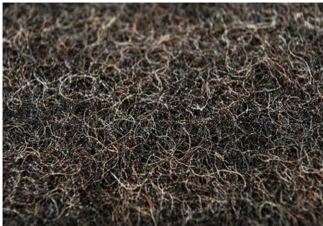
Конский волос обрабатывали различными способами. Самым лучшим из них считался способ кручения. Получаемый полуфабрикат почти без дальнейшей обработки мог быть использован в производстве. Кручёный волос проходил следующие процессы обработки: разборку, трёпку, прядение, завивку и варку.<sup>71</sup>
