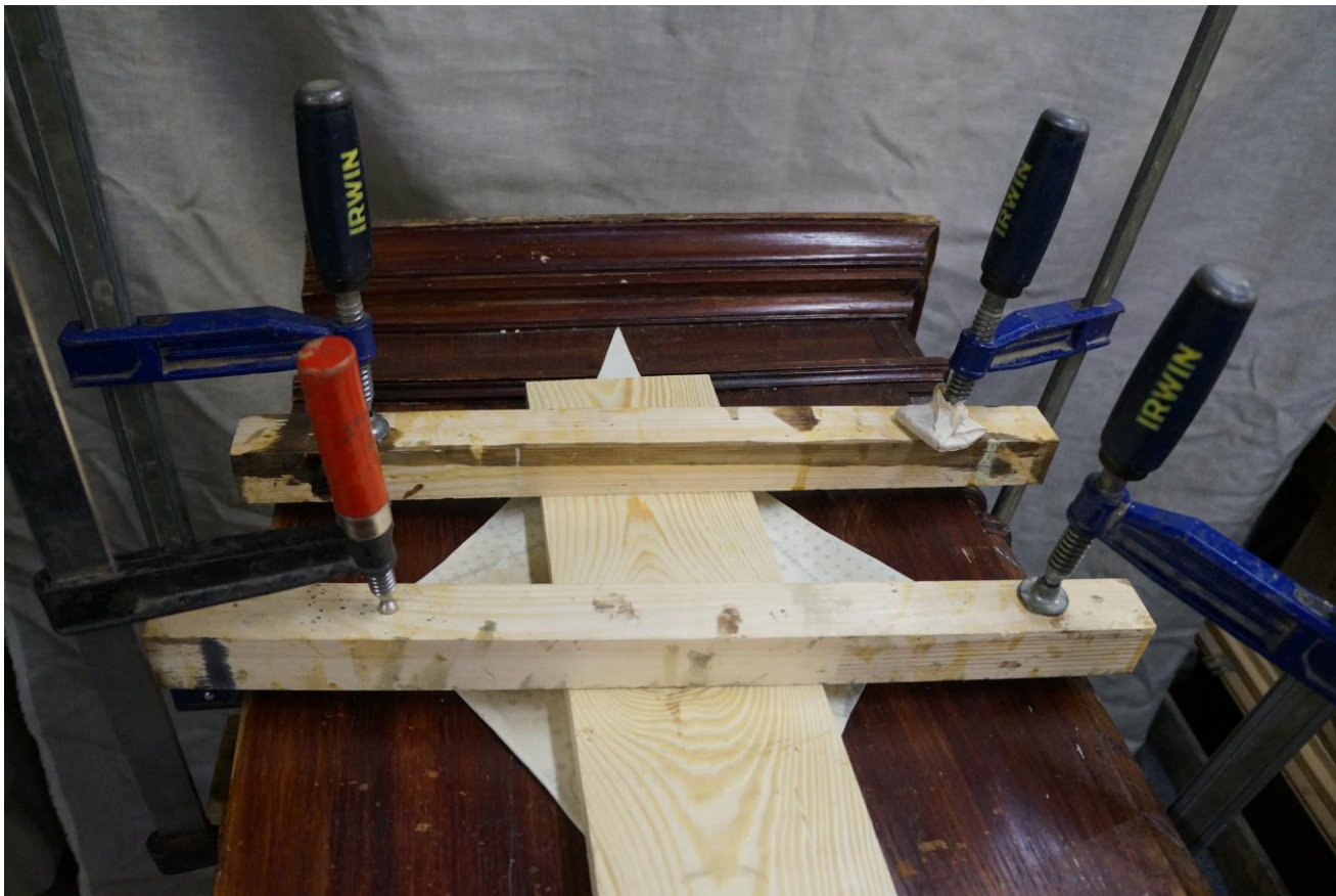
Фото №20. Переклейка фанеровки в местах отхода от основы на боковой стенке
