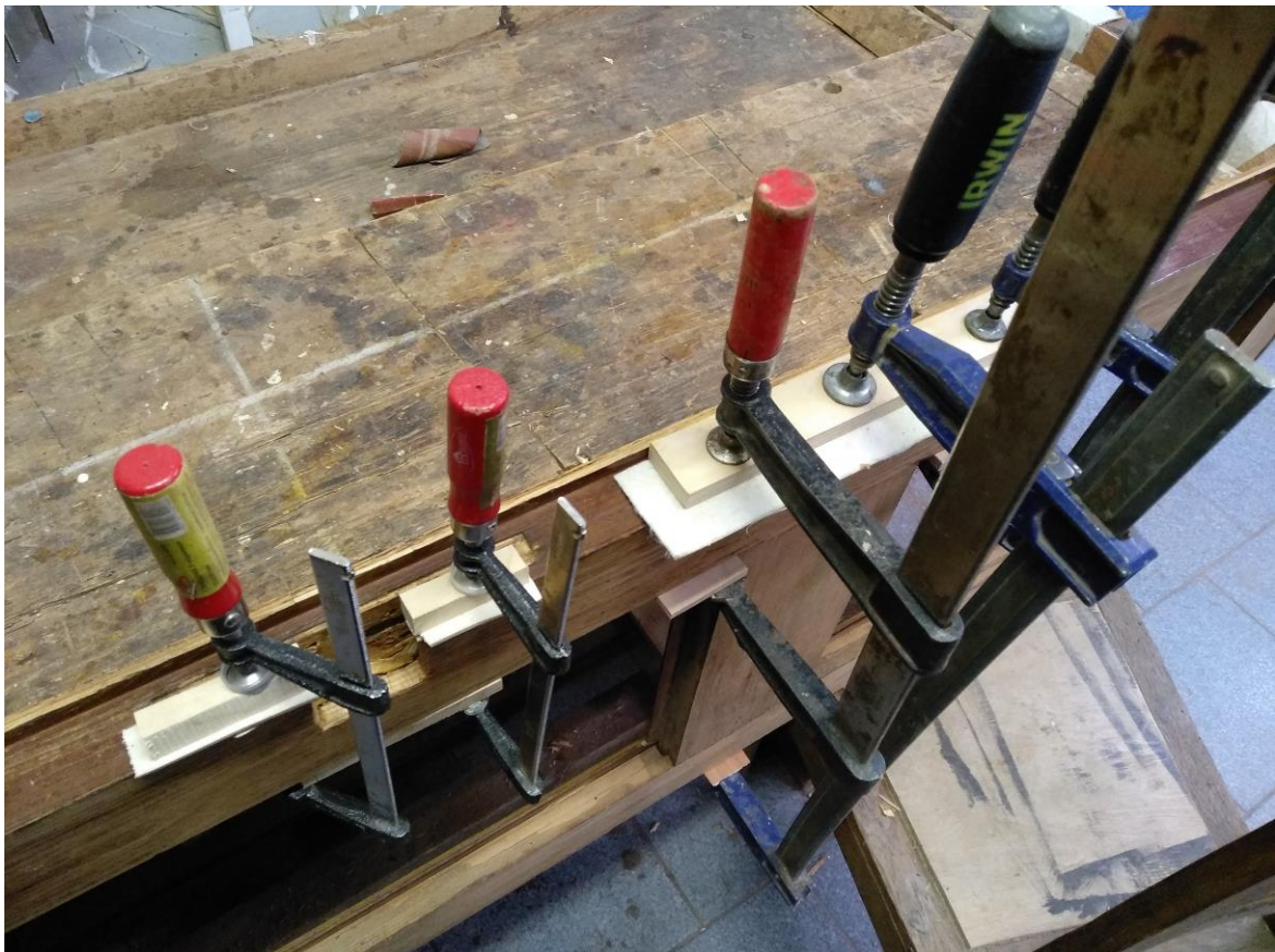
Фото №23. Проклейка фанеровки в местах отхода от основы на кромке двери
