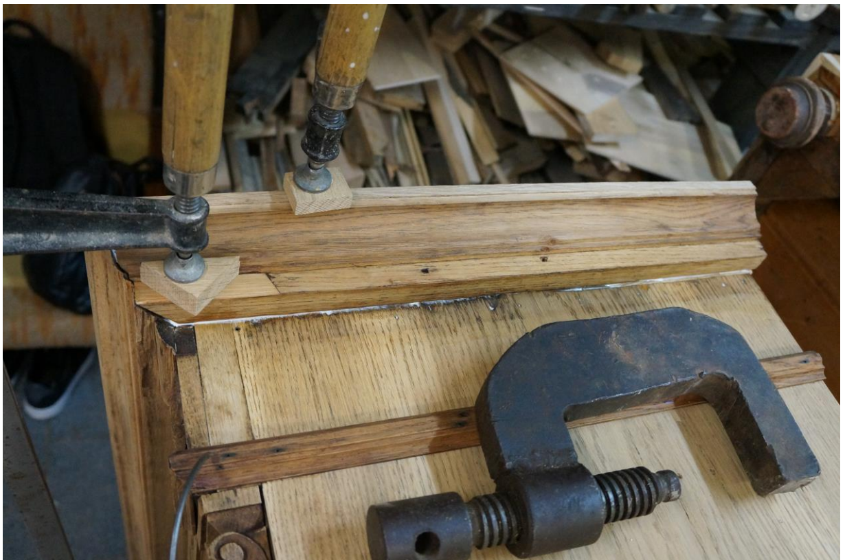
Фото №42. Приклейка карниза и профиля на левой боковине
