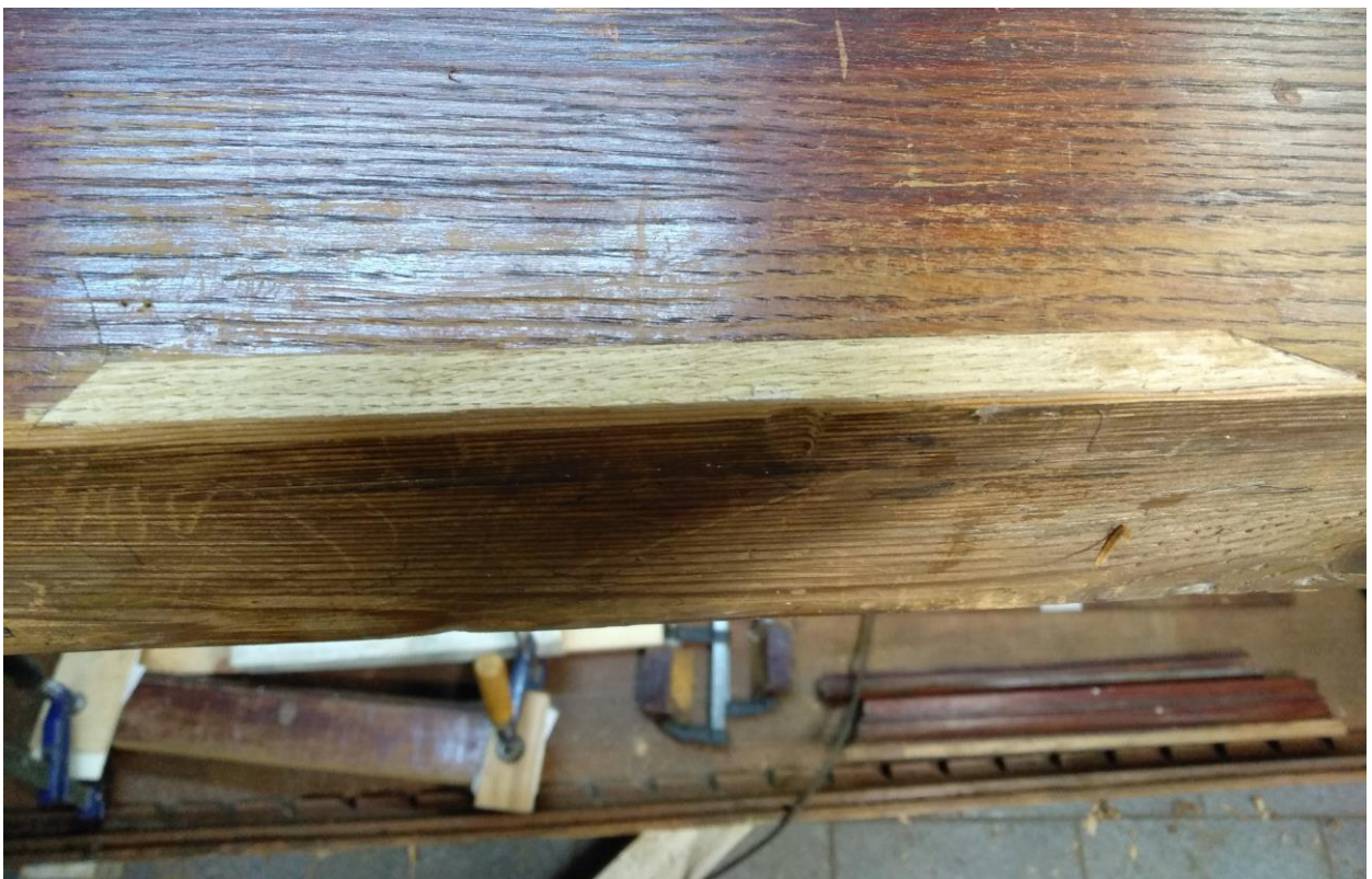
Фото №24. Изготовление вставок в места утрат фанеровки на боковине шкафа
