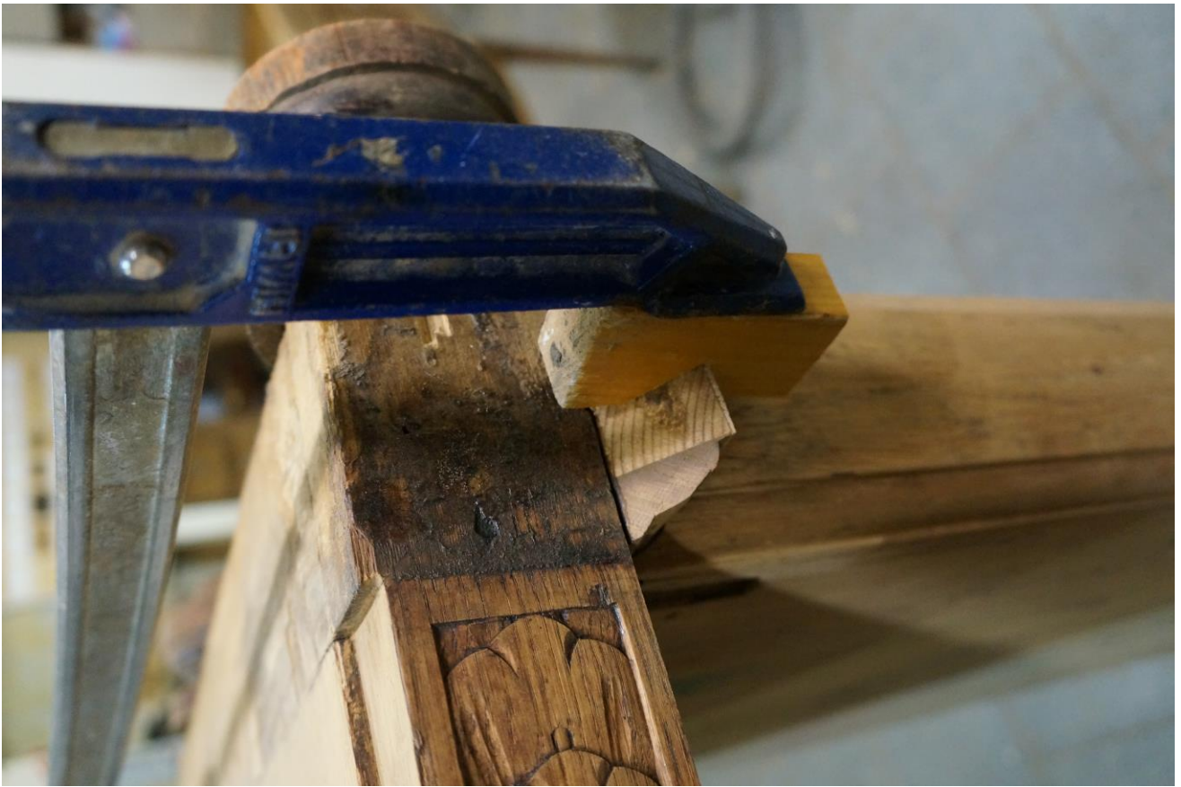
Фото №39. Приклейка раскреповки в основании шкафа
