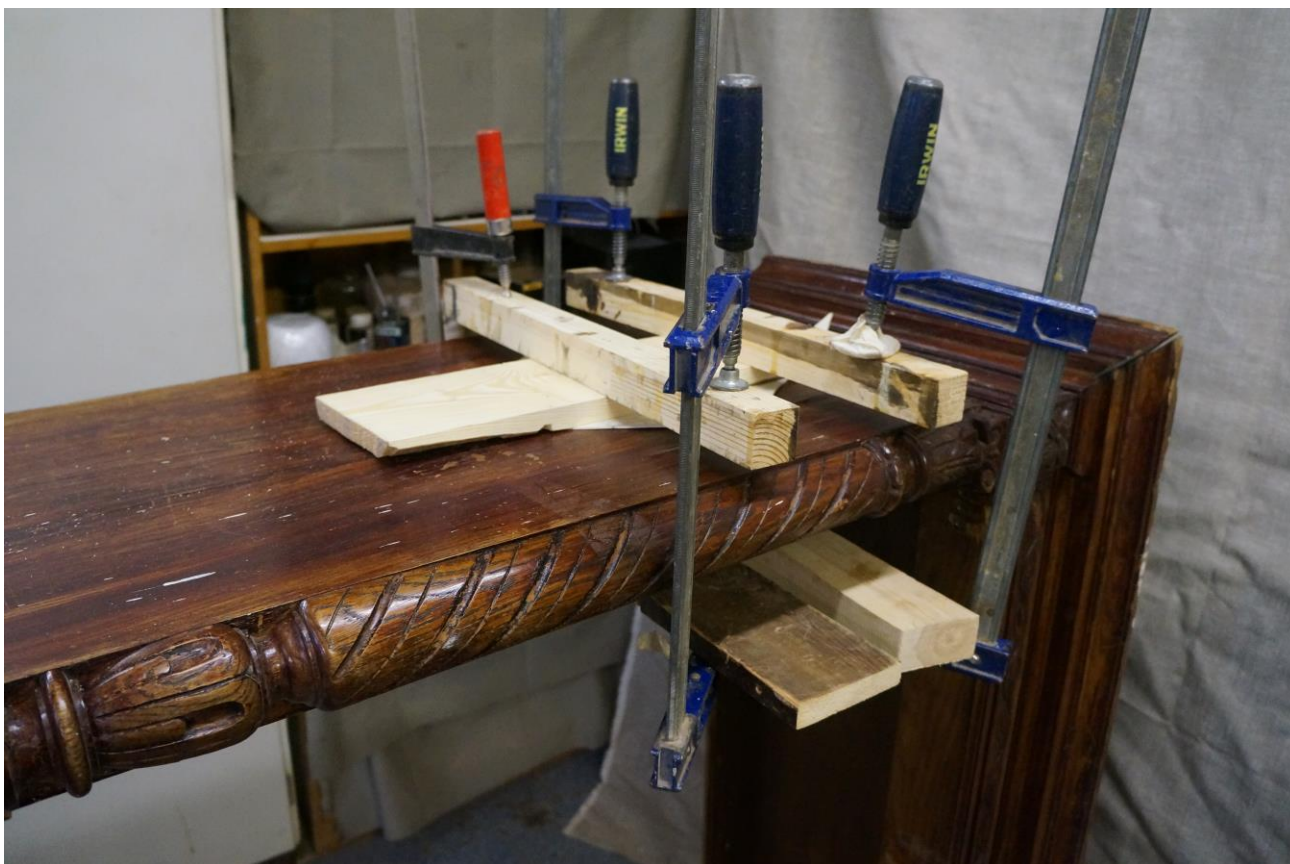
Фото №21. Переклейка фанеровки в местах отхода от основы на боковой стенке
