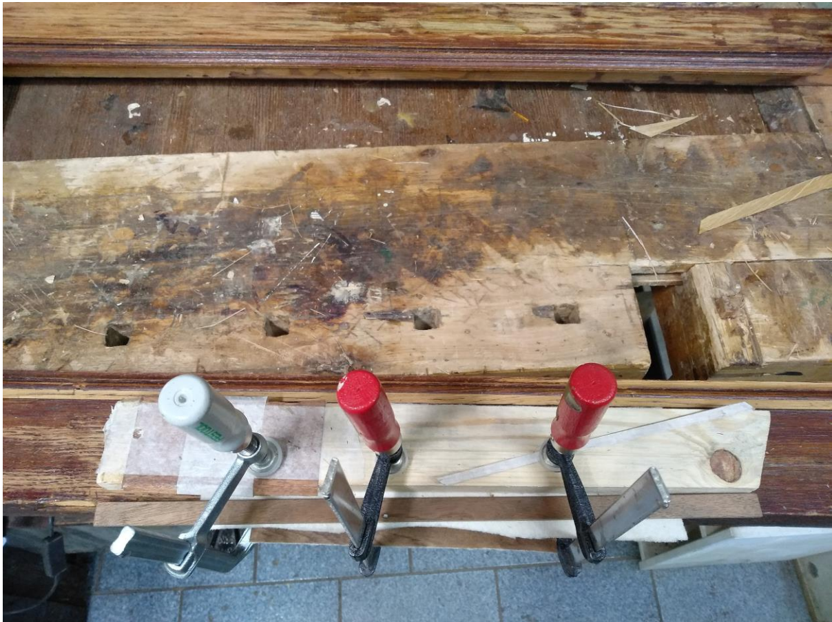
Фото №22. Проклейка фанеровки в местах отхода от основы на правой створке двери
