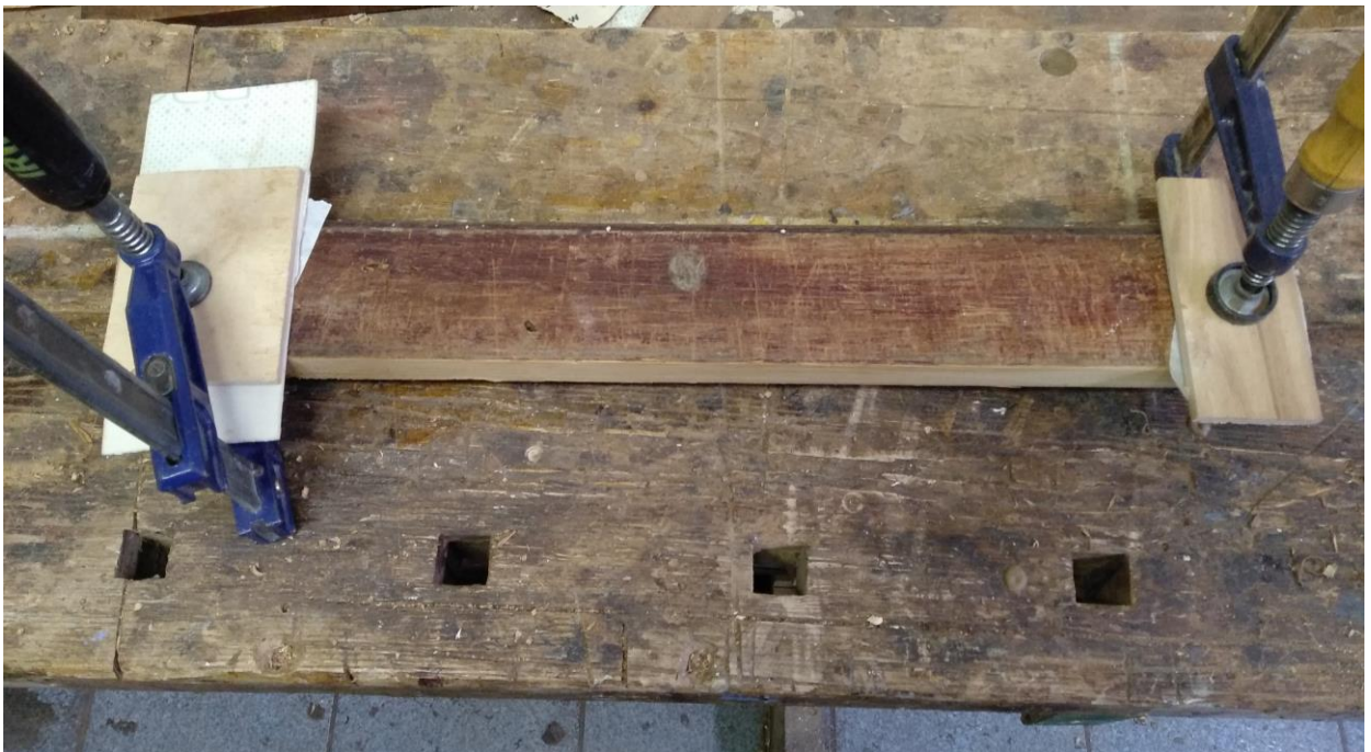
Фото №27. Изготовление вставок в места утрат фанеровки на плинте
