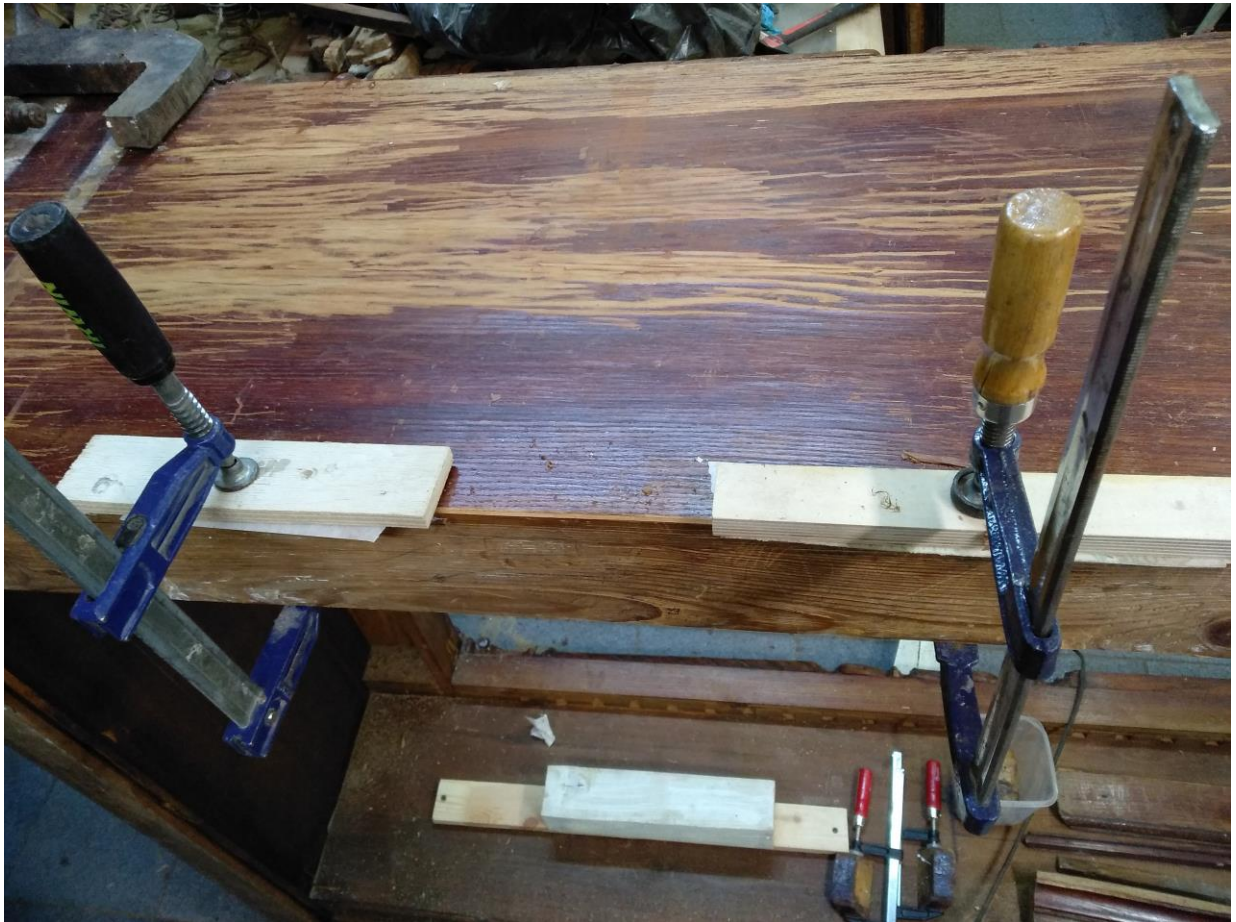
Фото №24. Изготовление вставок в места утрат фанеровки на боковине шкафа
