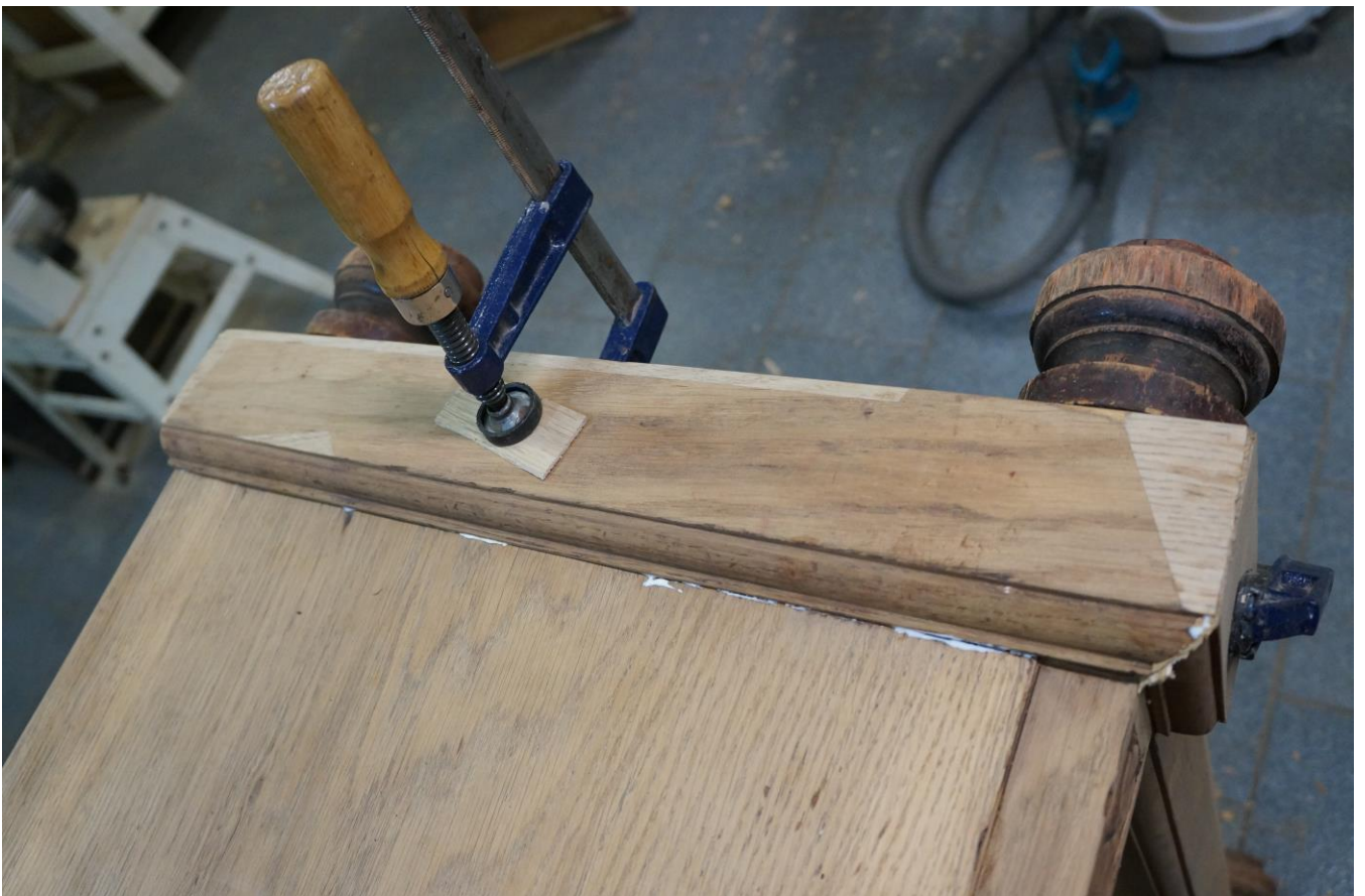
Фото №39. Приклейка раскреповки в основании шкафа
