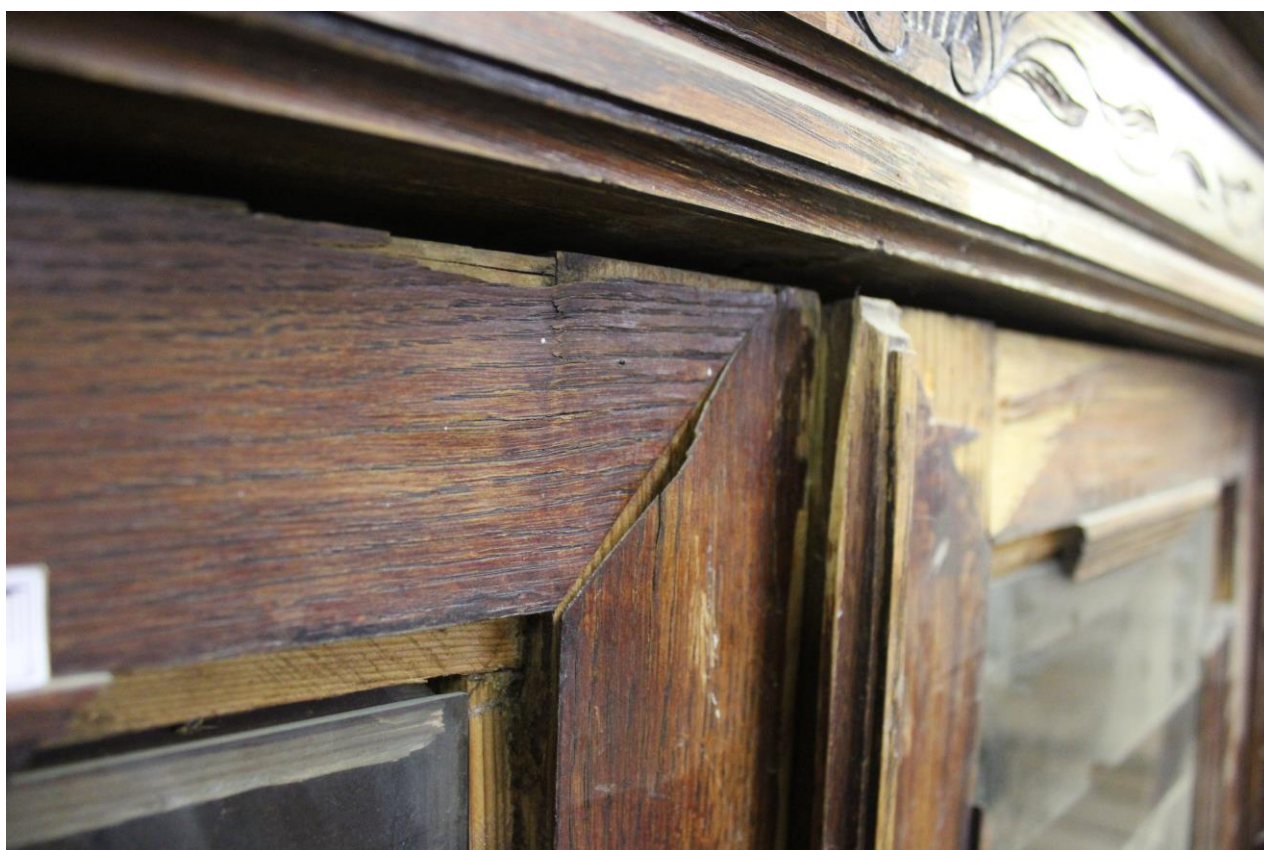
Фото №8. Отход фанеровки от основы на лицевой стороне двери
