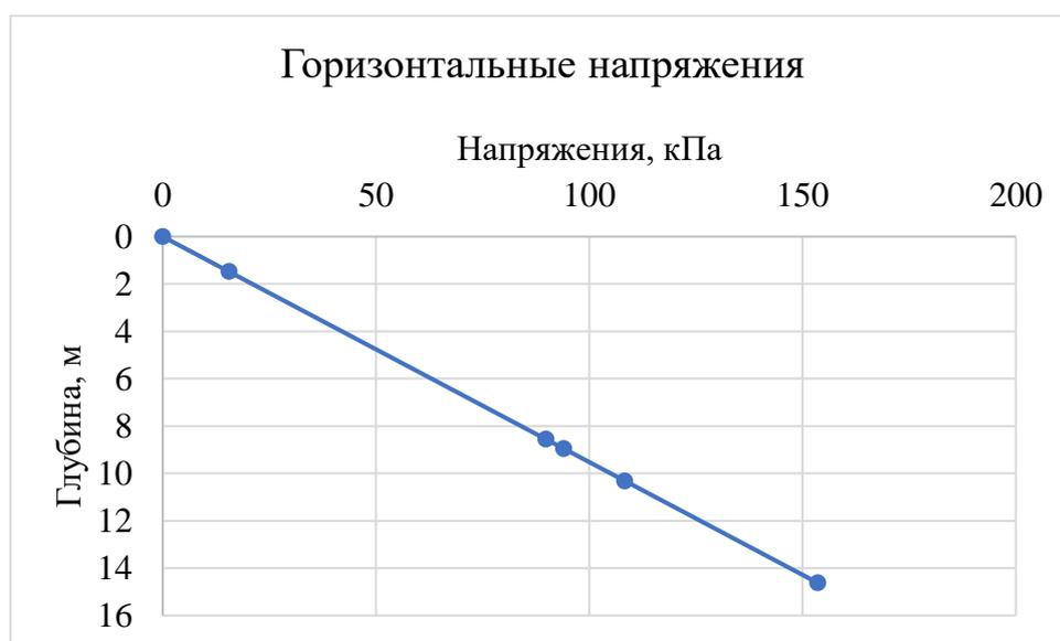
Рис. 17. График зависимости горизонтальных напряжений от глубины скважины (створ 4, глубина скважина 14, 63 м., абс. выс. 171,56 м.).
