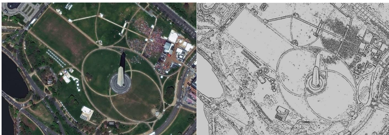
Рис. 6–7. Результат применения адаптивного порогового метода к спутниковому изображению
