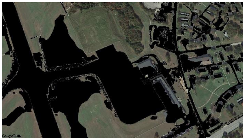
Рис. 20–21. Результат применения к тестовому изображению функций inRange() и bitwise_and() соответственно
