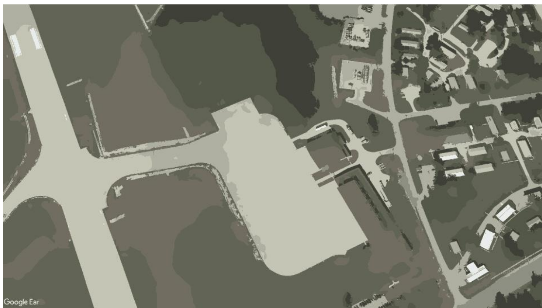
Рис. 19. Применение алгоритма kmeans() со значением количества кластеров равным 8
