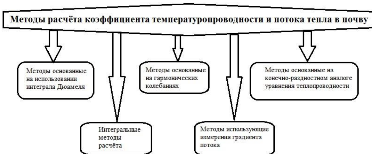
Рисунок 1. Блок-схема методов расчёта потока тепла в почву и коэффициента температуропроводности.
