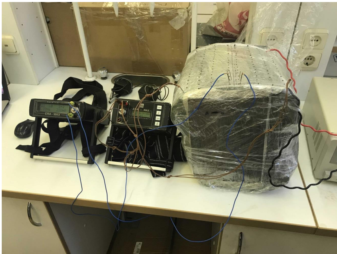
Рис. 15. Электрометрические измерения с помощью электроразведочной аппаратуры «ЭРА-МАХ».
