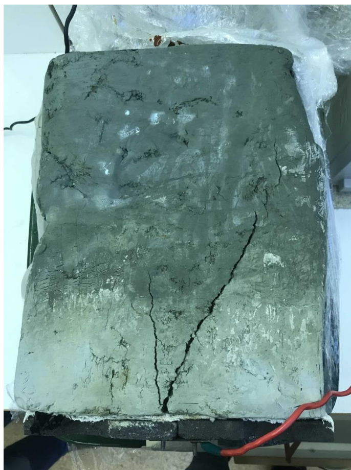
Рис. 19. Монолит кембрийской глины после поляризации постоянным током.
