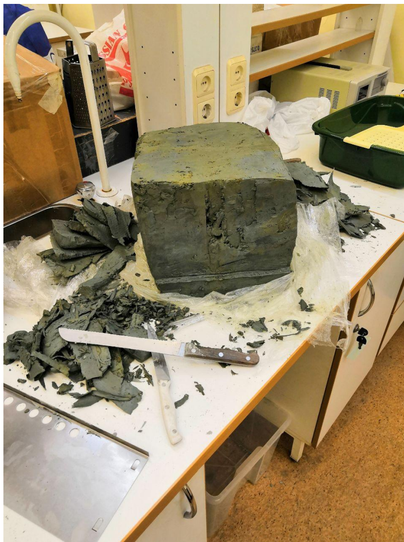
Рис. 11. Подготовка монолита кембрийской глины для проведения физического моделирования.
