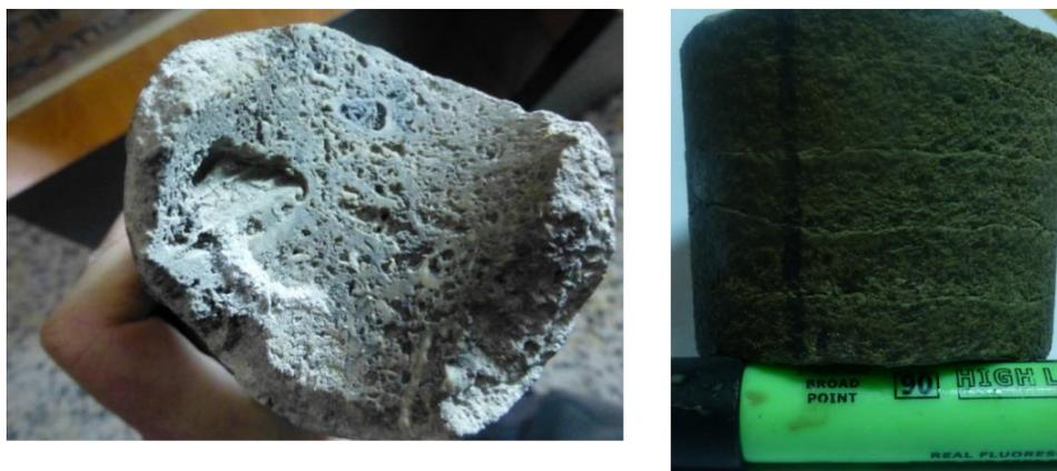
Рисунок 12 Образец керна интервала Мауддуд\_D (слева) и трещиноватость вдоль напластования (справа)
