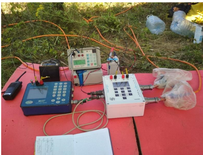
Рисунок 18– Аппаратура для электротомографии: генератор Astra (посередине), электроразведочный измеритель Meri (слева и коммутатор ComDD2(справа). Косы подключены к коммутатору. В целом, представлен вид переносимой операторской станции.
