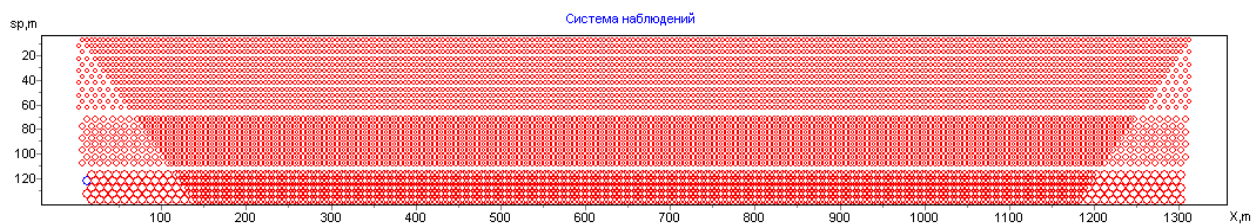
Рисунок 30– система наблюдений северного участка профиля с зонами перекрытия в программе ZondProtocol с равномерной плотностью измерений.
