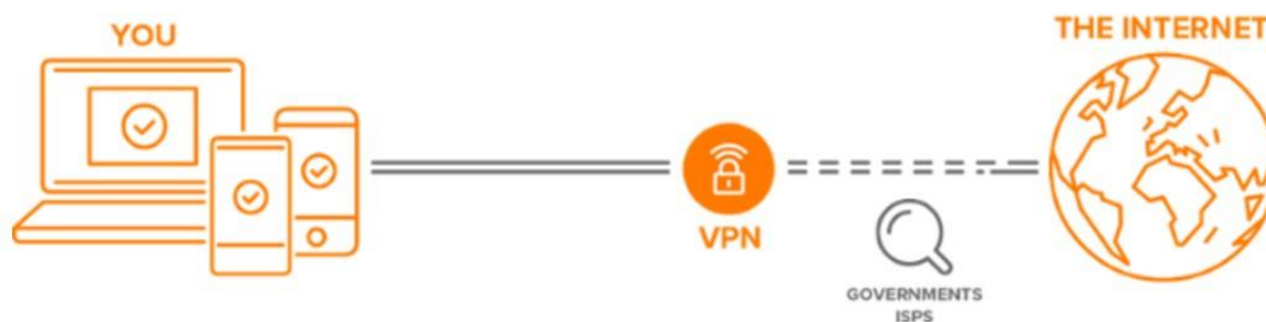
Рис. 29 Схема работы подключения VPN
