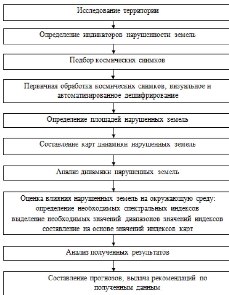
Рис. 12 Методика проведения мониторинга нарушенных земель с помощью космических снимков
