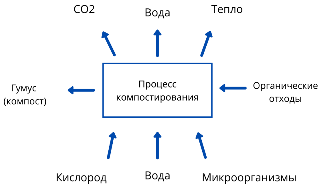
Рисунок 2.2 Процесс компостирования органических отходов [7].
