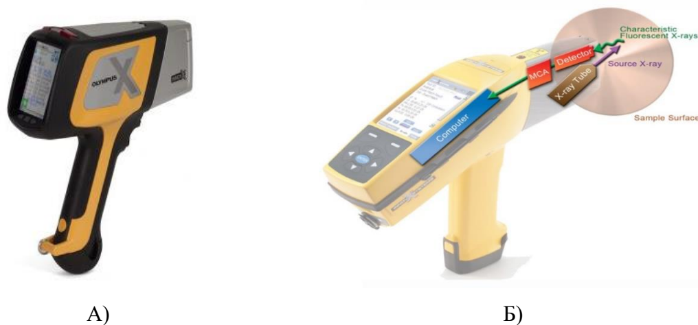
Рисунок 5.2 А) Портативный XRFанализатор (Olympus). Б) Принцип работы анализатора
