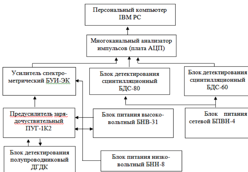
3.3. Блок-схема аналитического комплекса РАДЭК (Габитов, 2005)
