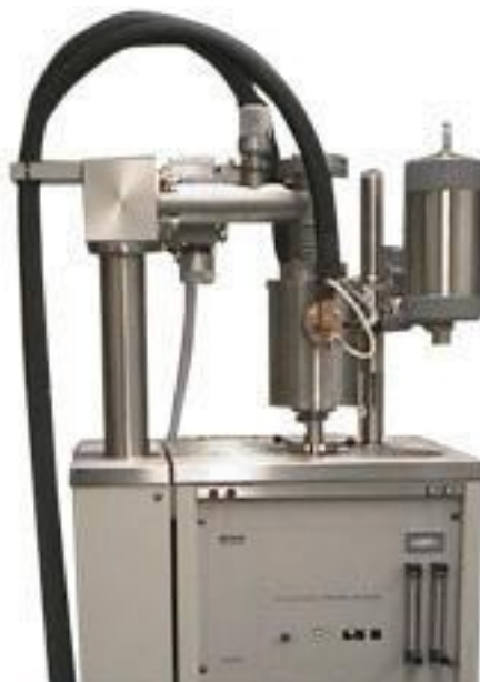
Рисунок 15. Фотография установки STA 429 CD, “NETZSCH” (Институт химии силикатов РАН)
