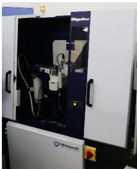
Рисунок 14. Фотография дифрактометра Rigaku «Ultima IV» (РЦ «Рентгенодифракционные методы исследований» СПбГУ).
