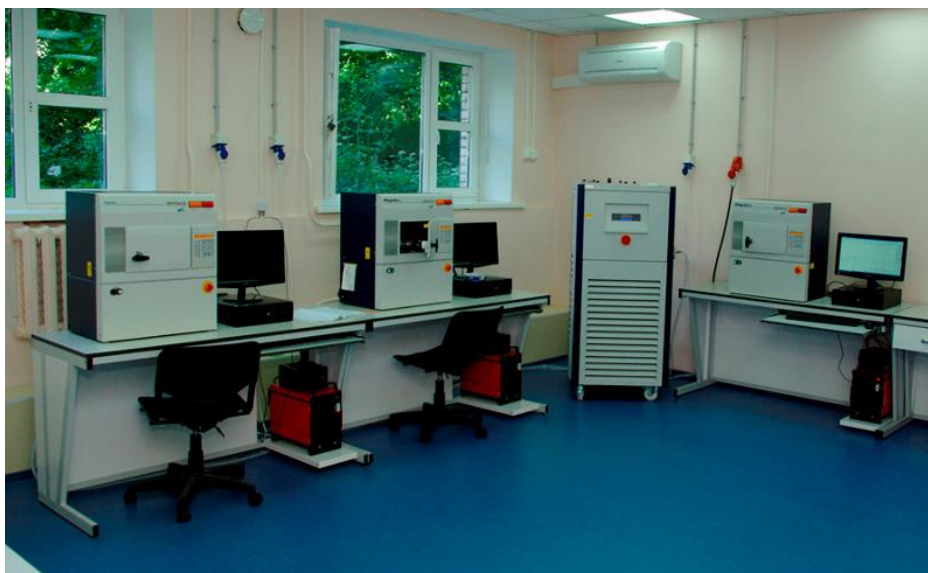
Рисунок 13. Фотография порошкового дифрактометра Rigaku “Miniflex II” (РЦ «Рентгенодифракционные методы исследований» СПбГУ).
