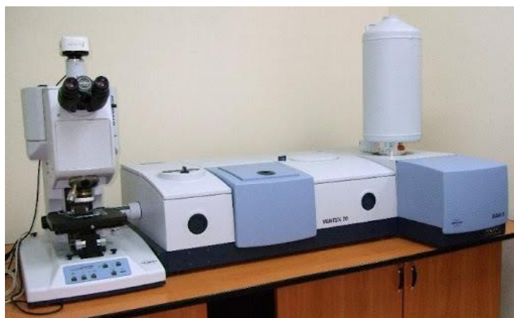
Рисунок 12. Фотография ИК Фурье-спектрометра Bruker Vertex 70 (РЦ «Рентгенодифракционные методы исследований» СПбГУ).
