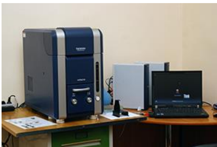
Рисунок 11. Фотография настольного растрового электронного микроскопа-микроанализатора ТМ 3000 (НИТАСНИ, Япония) (РЦ «Микроскопии и микроанализа» СПбГУ).
