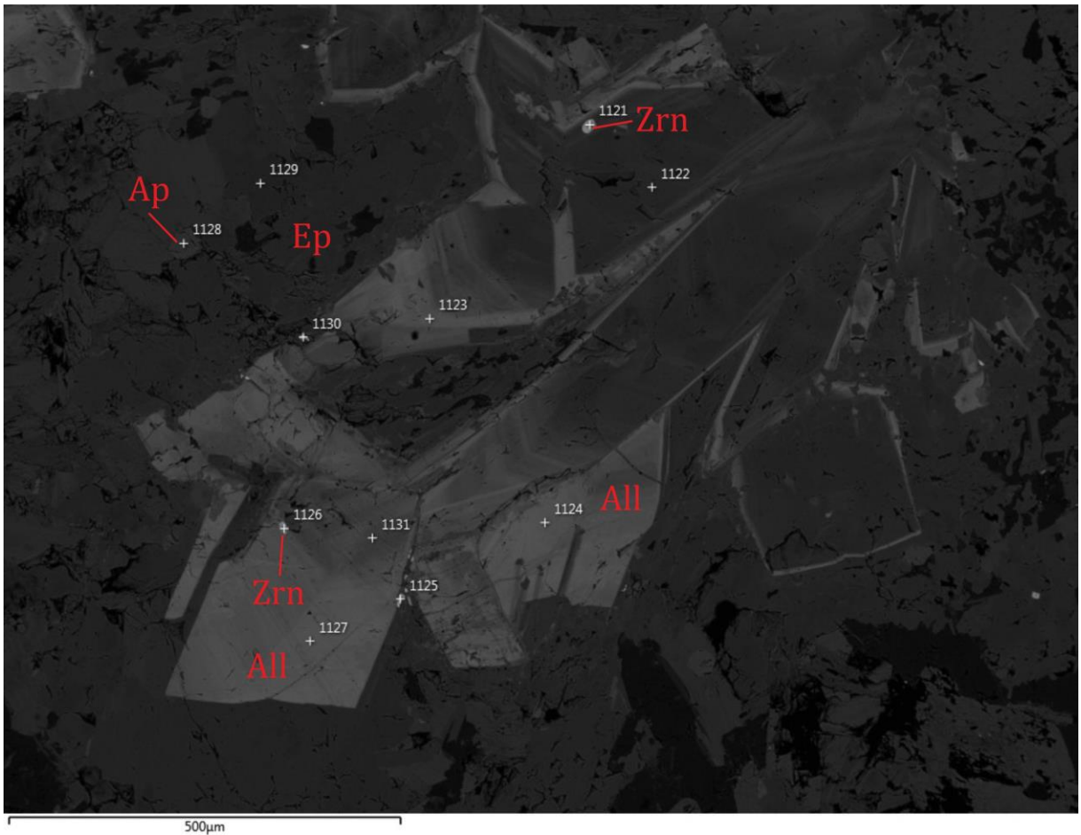
Рис. 10 Кристаллы алланита в габбро. Изображение в обратно-рассеянных электронах (BSE). All – алланит, Ap – апатит, Ep – эпидот, Zrn - циркон
