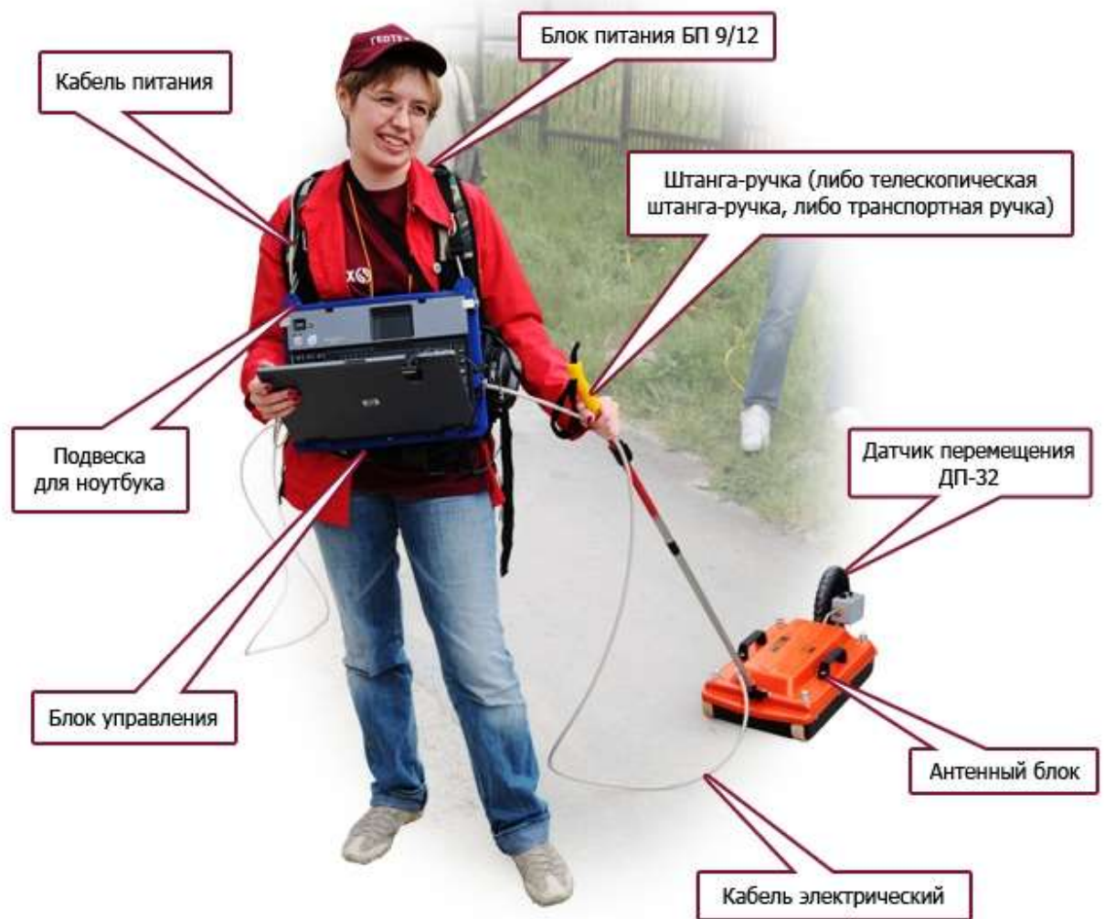
Рисунок 3. Вид и комплектация георадара "Око-2" [Радиотехнический прибор подповерхностного зондирования (георадар), 2009]
