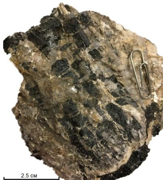
Рисунок 10. Образец ЮК-10 графической зоны пегматита Юканкоски с вытянутыми в одном направлении столбчатыми кристаллами чёрного турмалина (25-30%) в ассоциации с мусковитом (10-15%), полевым шпатом (35-40%), кварцем (20-25%).
