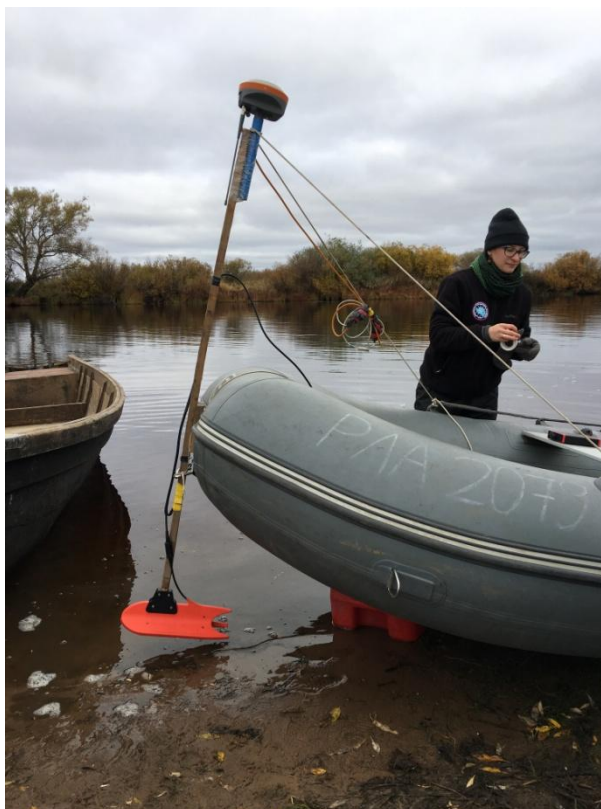
Рисунок 12 Крепление гидроакустической антенны и GPS-приемника
