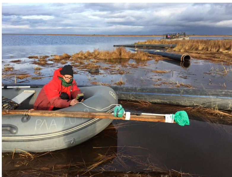
Рисунок 17 Крепление магнитометра МИНИМАГ-М к борту лодки
