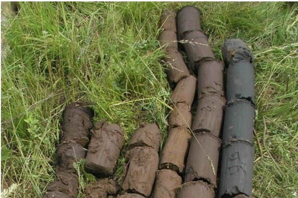
Рисунок 13. Керны, извлеченные в процессе бурения
