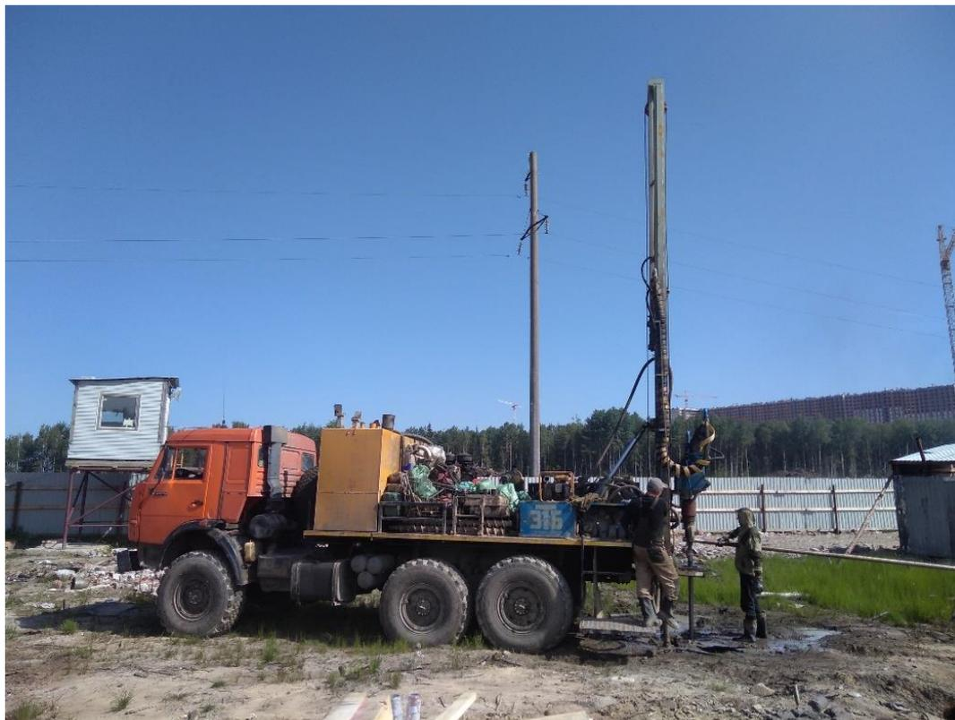
Рисунок 12. Буровая установка УРБ 2А2 на базе автомобиля КамАЗ.
