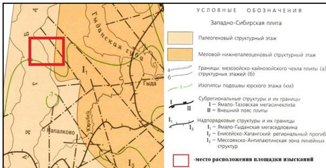
Рисунок 10 Участок схемы тектонического районирования в районе площадки изысканий (Дополнение к карте доплиоценовых образований. Лист R-43(45). Масштаб 1:1 000 000)
