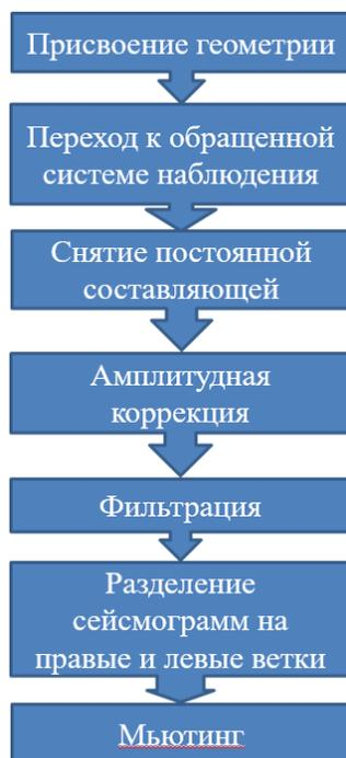
Рисунок 23 Граф обработки
