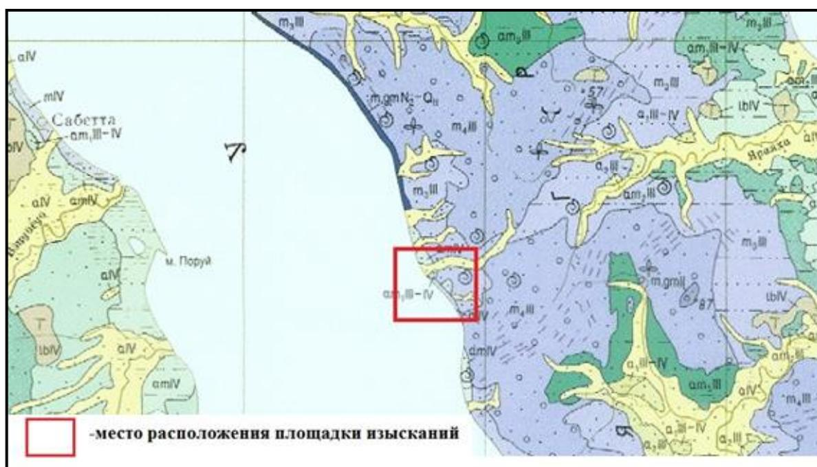
Рисунок 12 Схема распространения четвертичных образований (суша) в районе участка работ (Геологическая карта плиоцен-четвертичных образований. Лист R-43(45). Масштаб 1:1 000 000)
