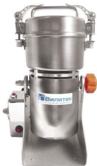
Рисунок 12. Лабораторная мельница VLM-20
