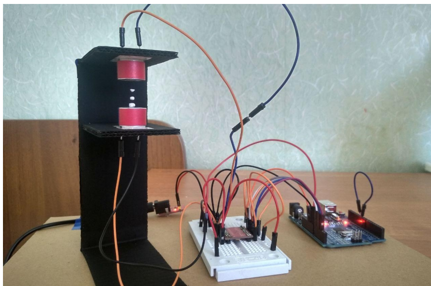
Рис. 6: Система собрана с использованием Arduino Uno, драйвера TB6612FNG и двух ультразвуковых излучателей. На узлах стоячей волны расположены шарики пенопласта.
