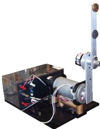
Рис. 2. Вариант практической реализации двухзвенного робота-манипулятора.
