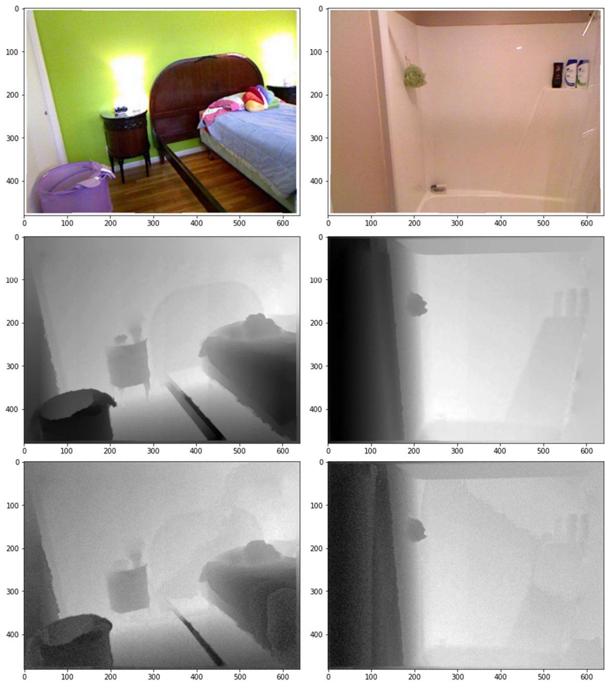
Рис. 11 Результаты предсказания карты глубин. Сверху вниз: исходное изображение, истинная карта глубины, предсказанная карта глубины.
