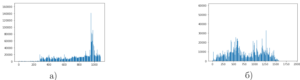
Рис. 3: Гистограммы проекций кадра с высокой контрастностью: а) проекция на вертикальную ось б) проекция на горизонтальную ось.
