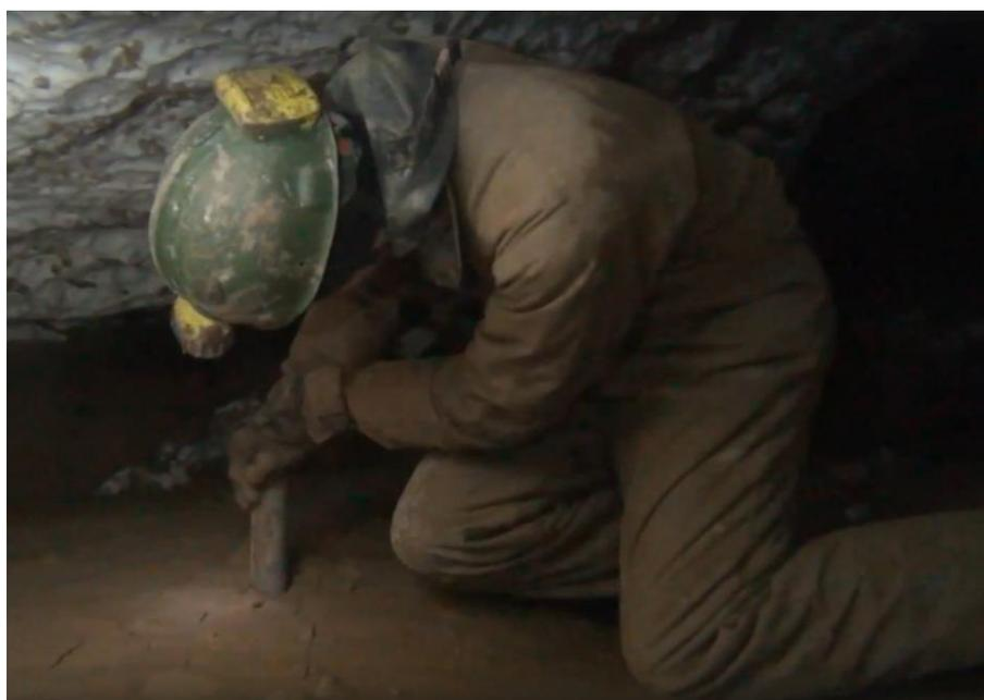
Рис. 2.12 Процесс отбора керна ВМО с помощью пробоотборника (Фото И.Э. Вяххи).
