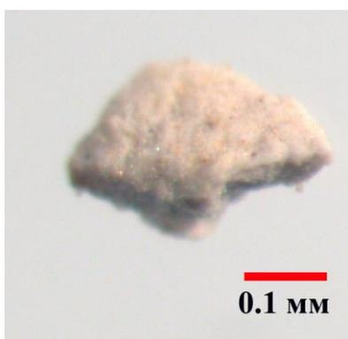
Рис.4.21. Тонкозернистый агрегат гипса. Обр. К4-10-1
