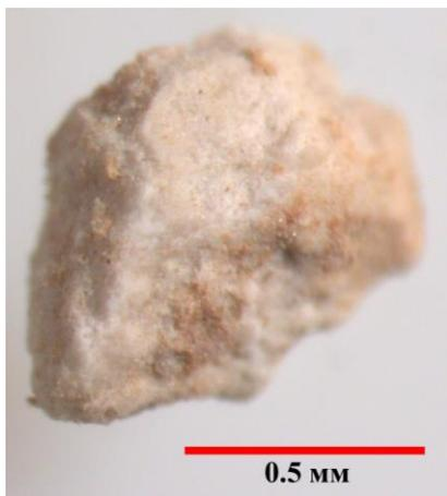
Рис.4.28. Тонкозернистый агрегат гипса. Обр. К4-12-2
