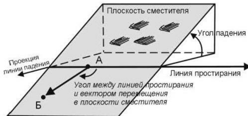
Рисунок 12. Схема измерения угла подвижки в лежащем крыле (Ребецкий и др., 2017).
