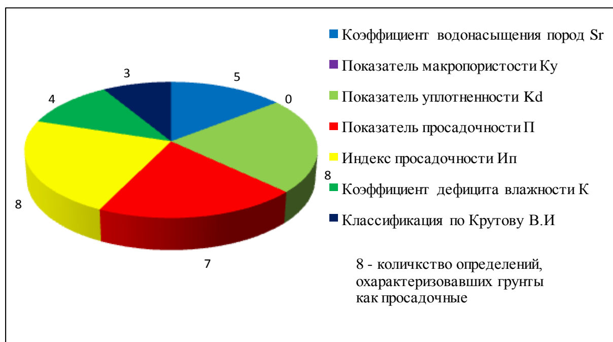
Рисунок 10. Оценка склонности грунтов к просадочным явлениям по косвенным показателям на участке № 1
