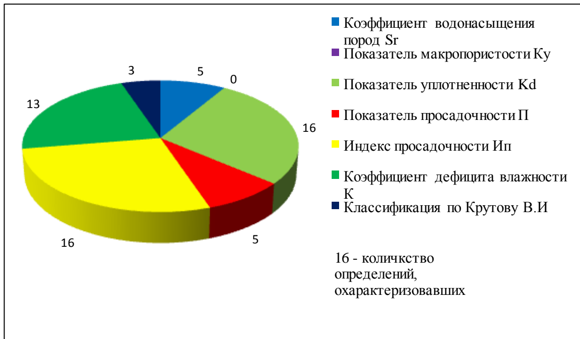
Рисунок 11. Оценка склонности грунтов к просадочным явлениям по косвенным показателям на участке № 2
