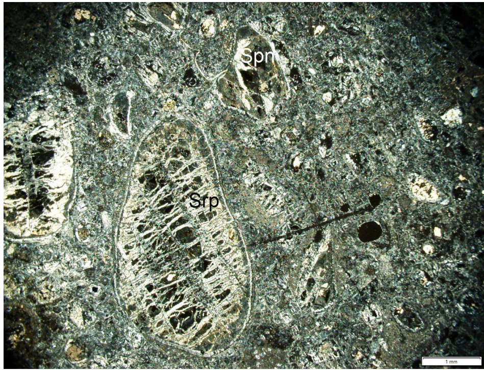
Рисунок 36. К174, автолитовая текстура, псевдоморфозы сапонита и карбонатов по оливину (Srp – серпентин, Spn – сапонит, масштаб – 1мм).
