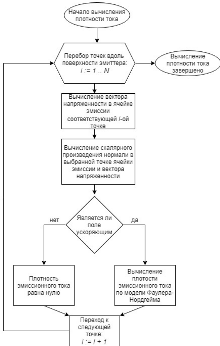
Рис. 9: Блок-схема вычисления плотности эмиссионного тока по модели Фаулера – Нордгейма на одном временном шаге
