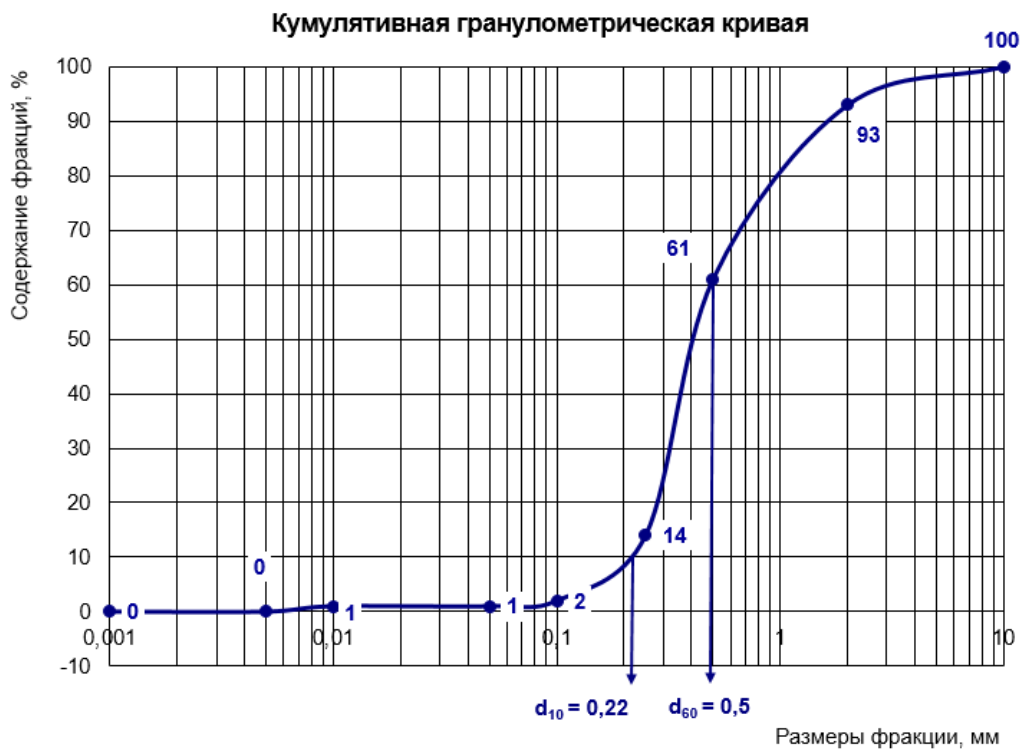
Рис.46. Кумулятивная гранулометрическая кривая, характеризующая коэффициент
