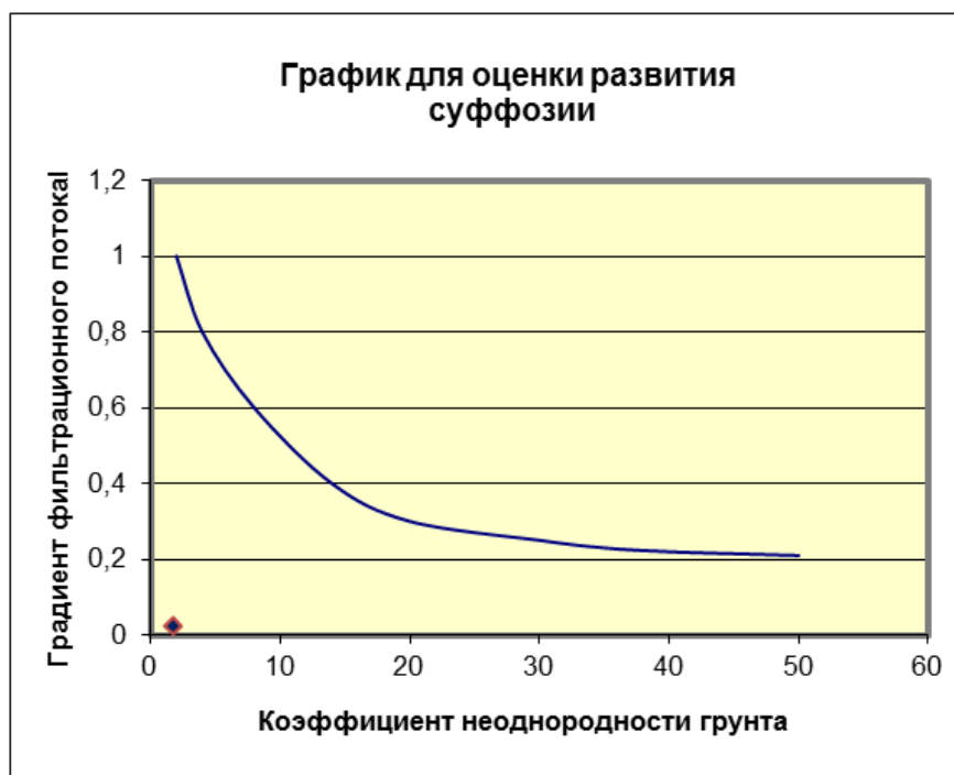
Рис. 19. Прогноз развития суффозии в мелкозернистых песках на участке Светлогорск по графику Истоминой.
