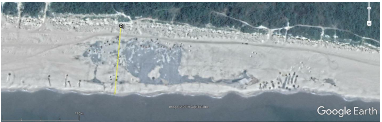
Рис.40. Воронки размыва пляжа при несанкционированной добыче янтаря. Космоснимок 2018 г. (отчет ВСЕГЕИ, 2019)
