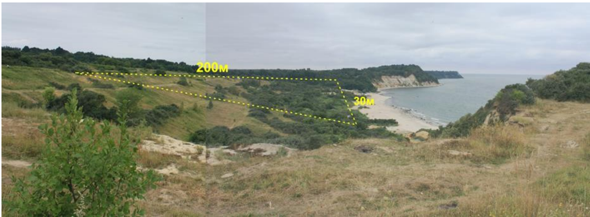
Рис.22. Террасированный участок побережья в районе пос. Филино. Желтым цветом показаны условный контур побережья до террасирования (Отчет ВСЕГЕИ, 2019).
