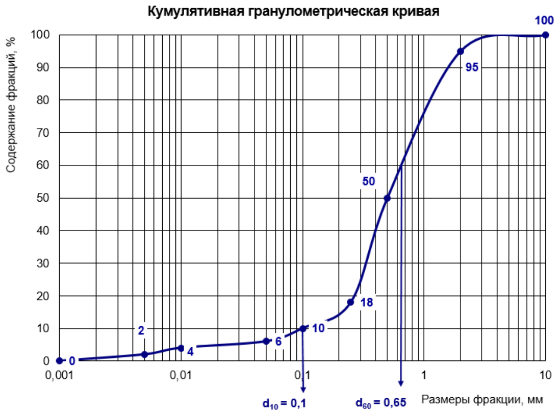
Рис.31. Кумулятивная кривая для крупных песков, залегающих над суглинками в нижней части разреза абразионного уступа на участке Филино.
