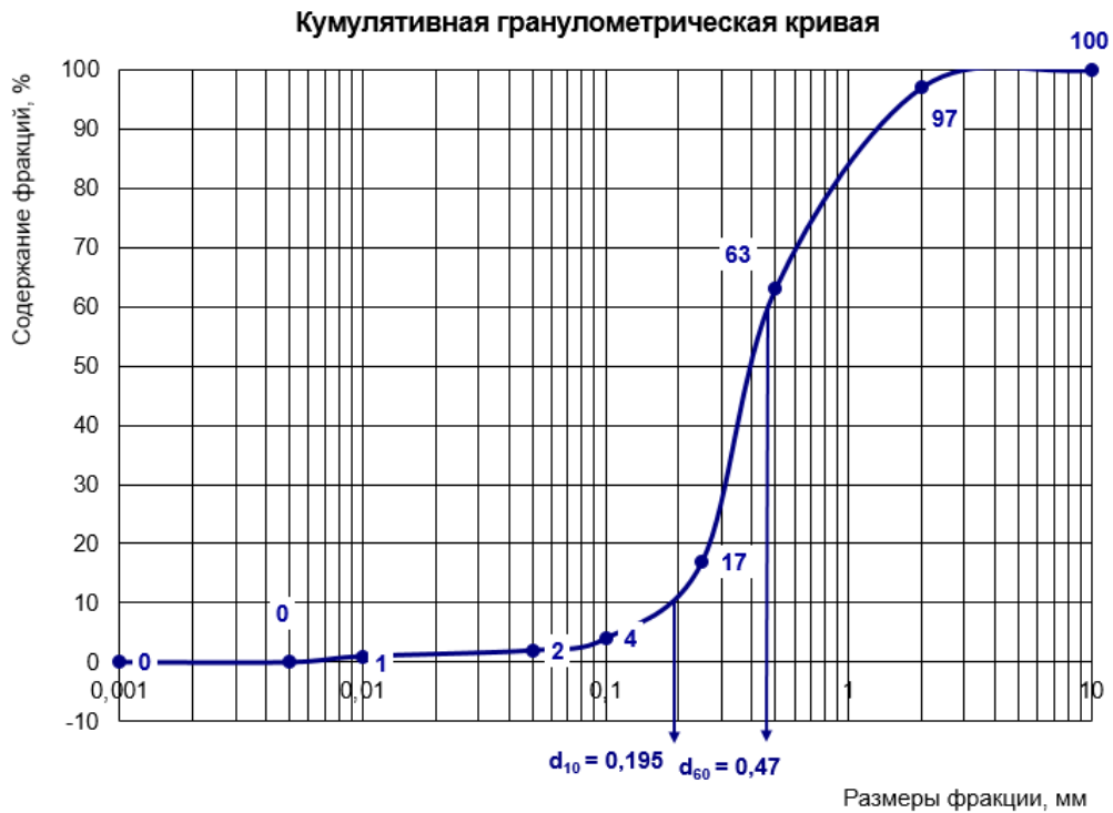
Рис.25. Кумулятивная гранулометрическая кривая кварцево-глауконитового песка (Pg 3 ) на участке Филино
