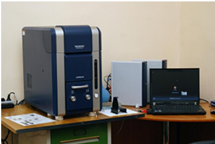
Рис. 17. Растровый электронный микроскоп-микроанализатор ТМ 3000 (HITACHI, Япония)
