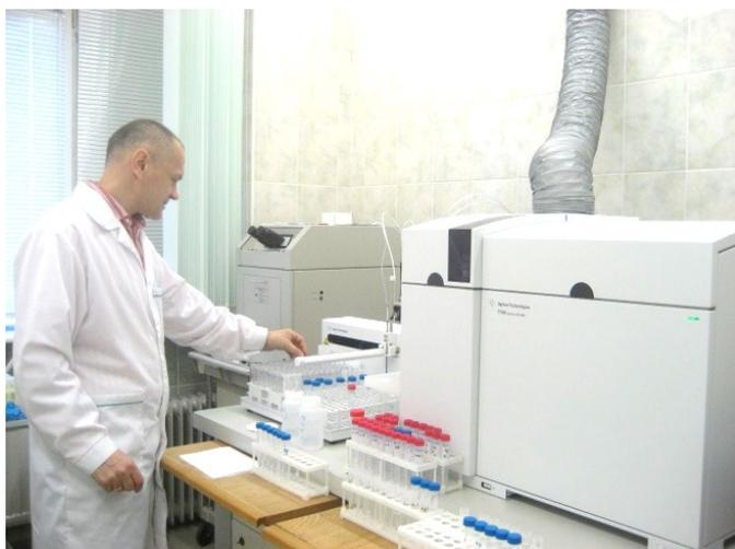
Рис. 16. Квадрупольный масс-спектрометр с индуктивно связанной плазмой Agilent 7700x (Agilent Technologies)
