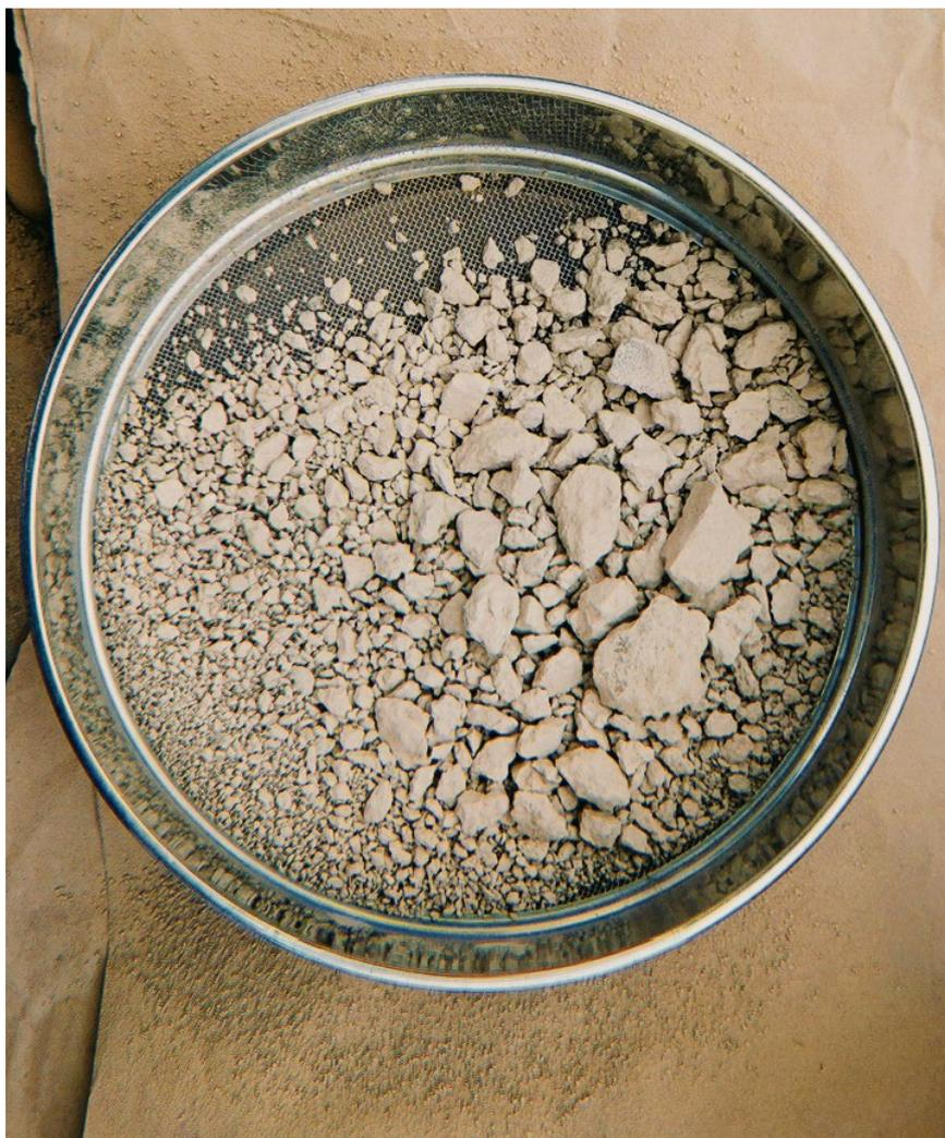
*Рис. 14.* Процесс просеивания пробы через сито с ячейкой 1 мм.
