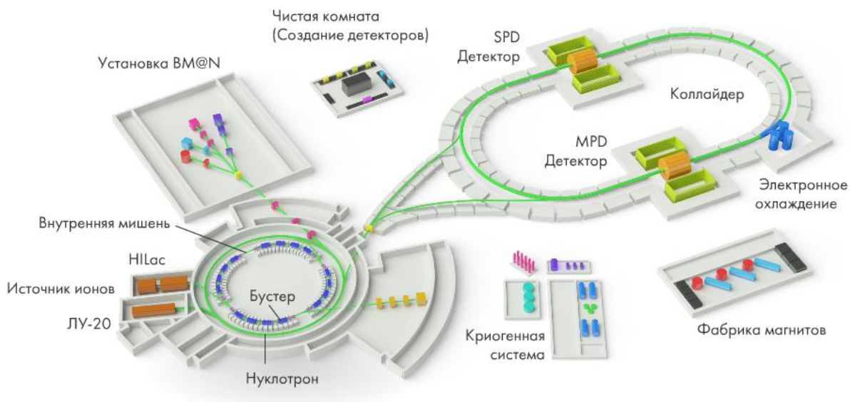
Рис.1. Схема ускорительного комплекса NICA
