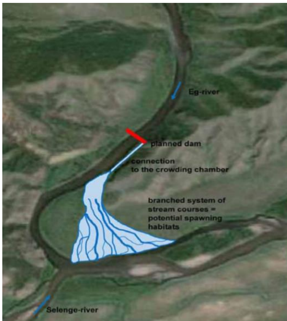
Рисунок 4 – Схематическое изображение предлагаемой искусственной системы разветвленных водотоков для нереста вниз по течению от плотины реки Эгийн-Гол в качестве меры по смягчению утраченной естественной нерестовой среды обитания (Report of the FAO, 2014).
