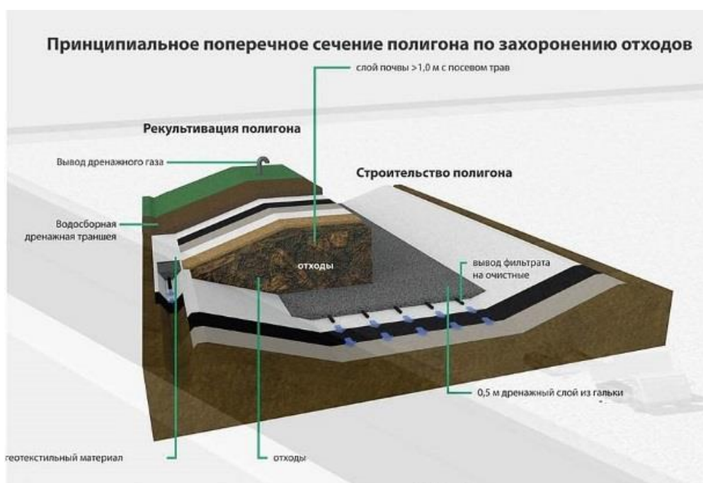
Рис.1 Поперечное сечение полигона по захоронению отходов.
