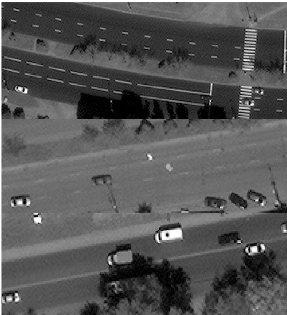
Рисунок 5 - Участки с эталонным (сверху), неудовлетворительным состоянием (по середине) и фактическим отсутствием (снизу) разметки 1.5
