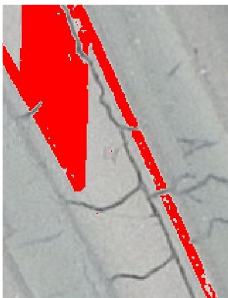
Рисунок 7 - Результат классификации без обучения, позволяющий оценить процент сохранности разметки заезда на автодорогу
