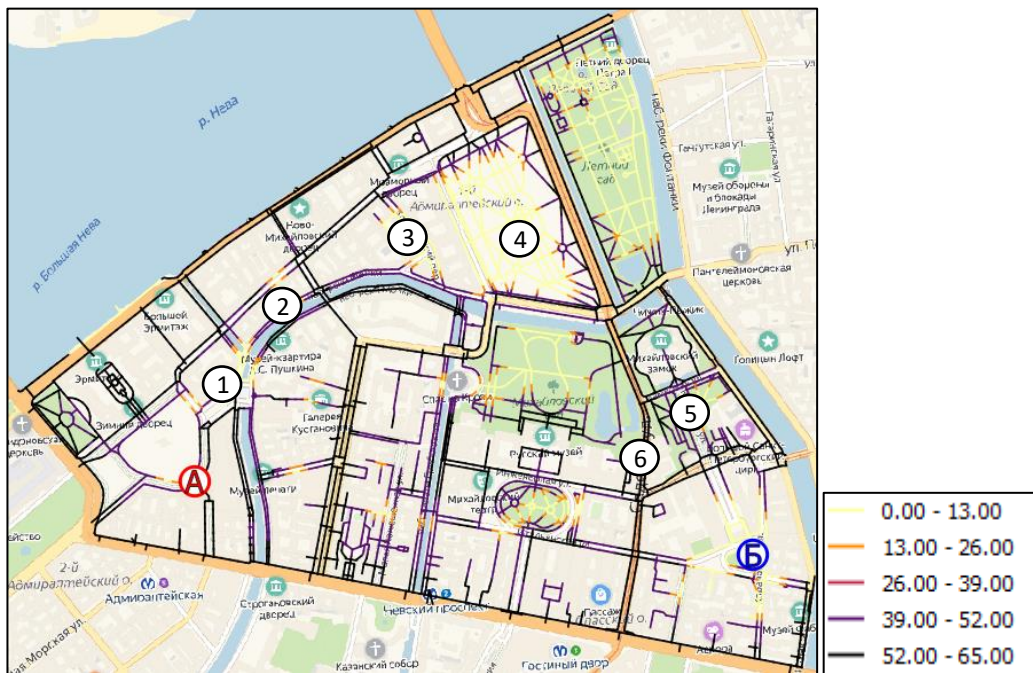
Рис.41. Изображение графа пешеходных дорог с отображением весовых значений шумового загрязнения
