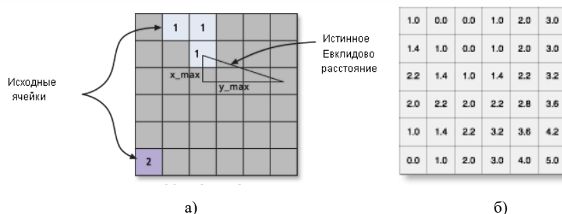
Рис. 14. Определение истинного евклидового расстояния на растре. а) – исходный растр, б) – выходной растр. Источник: https://desktop.arcgis.com/ru/arcmap/10.3/tools/spatial-analyst-toolbox/understanding-euclidean-distance-analysis.htm - справочник по инструментам ArcGIS.
