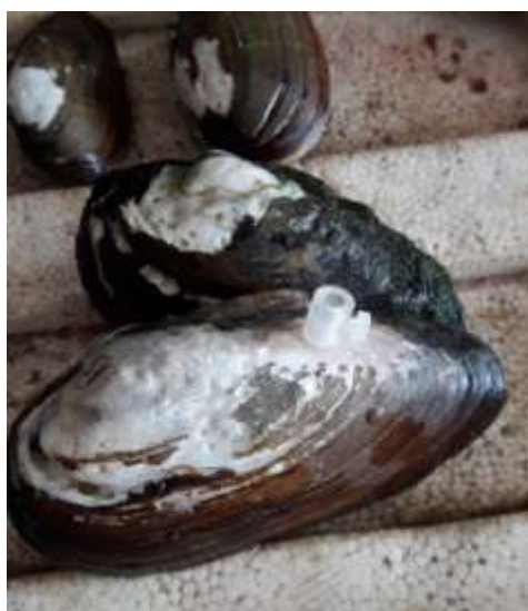
Рис. 8. Моллюск с наклеенным миниатюрным держателем волоконно-оптического зонда (фото автора)
