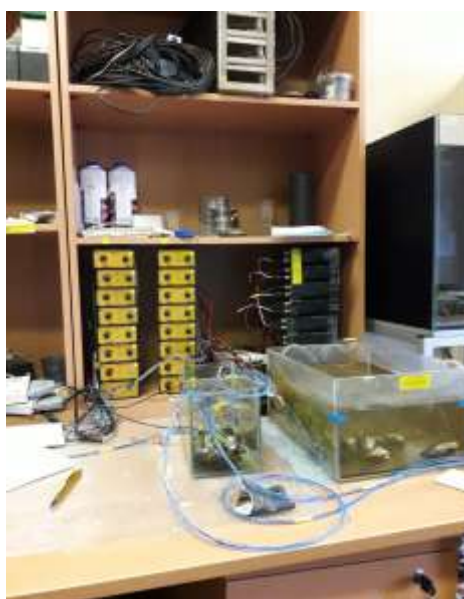
Рис. 11. Установка для многоканальной регистрации кардиоактивности животных (фото автора)
