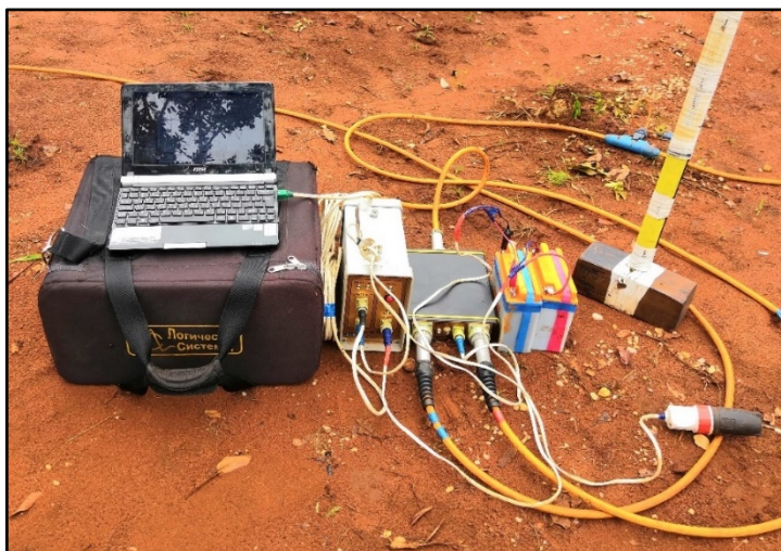
Рисунок 13 Сейсмическая станция «Лакколит X-M2»
