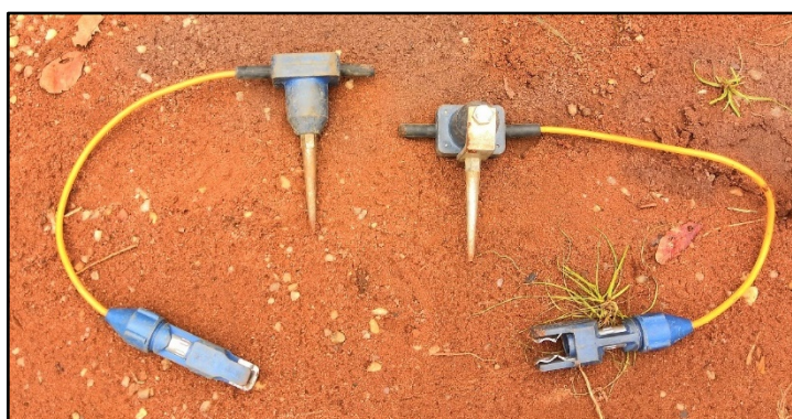
Рисунок 14 Вертикальный (слева) и горизонтальный (справа) электродинамические сейсмоприемники OYO-Geotimpulse
