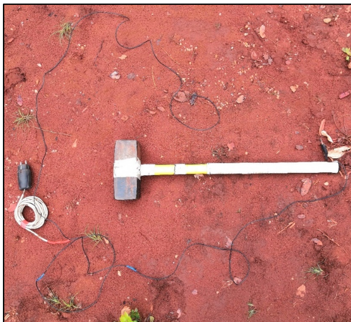
Рисунок 15 Кувалда и провод синхронизации, подведенный к ней
