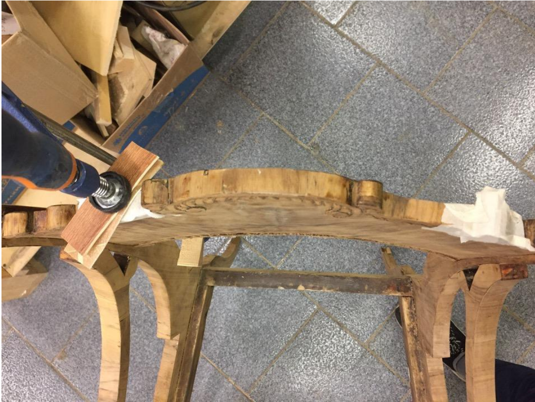
Фото№51. Окантовка щитка спинки. Восполнение утрат фанеровки.
