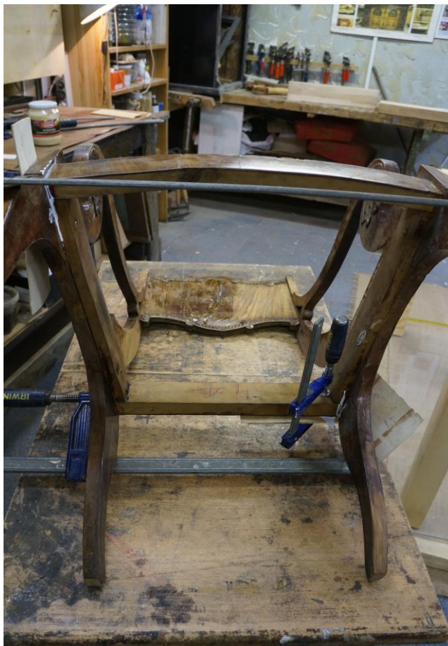
Фото №39. Царговый пояс. Укрепление конструктивных элементов.
