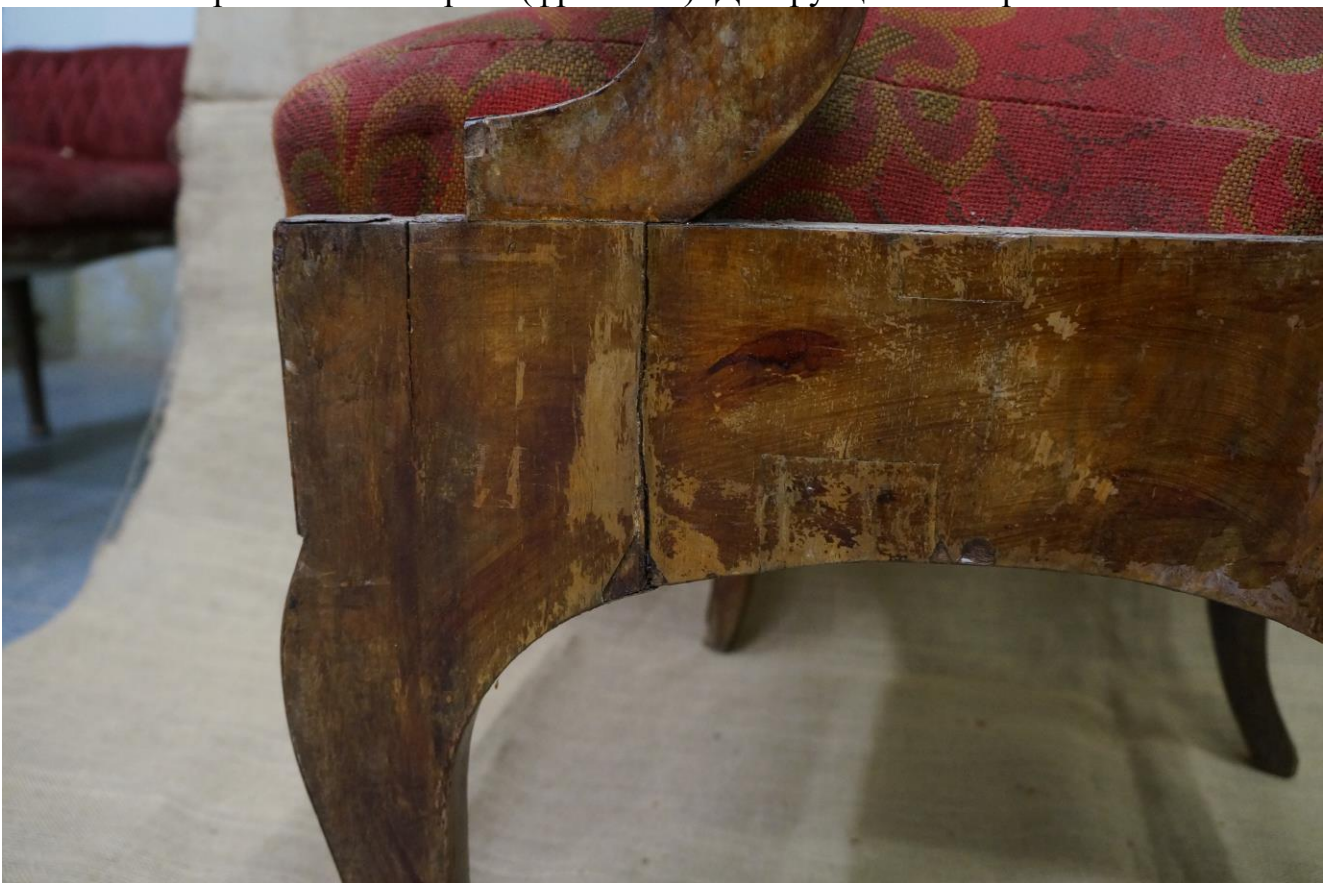
Фото №24. Правая боковая рама(фрагмент). Разрывы фанеровки, отслоение фанеровки от основы, деструкция лакокрасочного слоя, утраты фанеровки.
