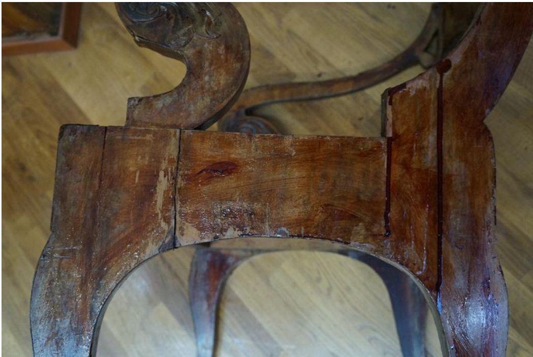
Рис.6. Цельнобоковая рама правая. Разрывы основы и фанеровки. Остатки отделочного слоя разной толщины, цвета и степени сохранности
