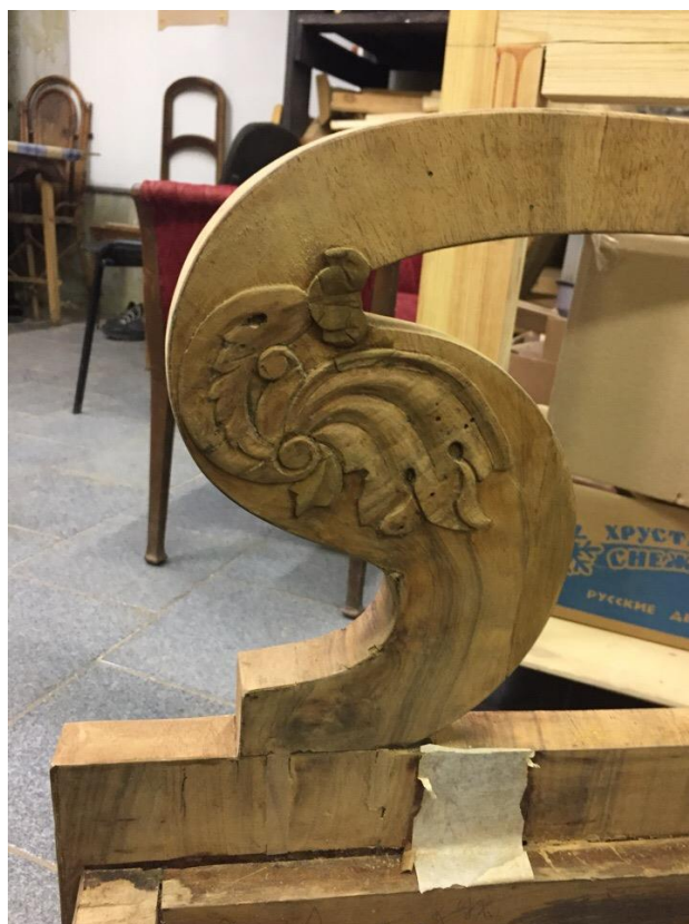
Фото№60. Левый локотник (внутренняя часть). Восполнение утраченной резьбы
