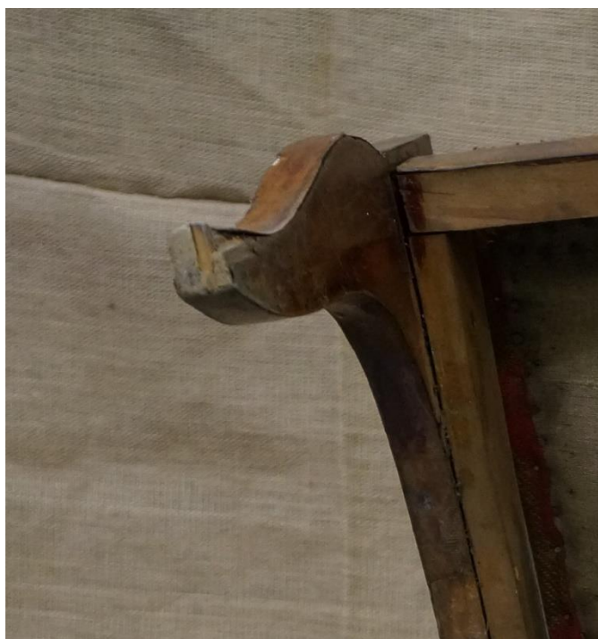
Рис.18. Скол материала в окончании левой передней ножки (фрагмент)
