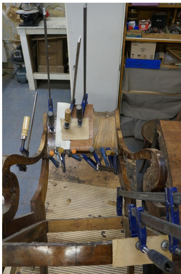
Фото №40. Укрепление облицовки на левом локотнике ,щитке спинки, передней царге.
