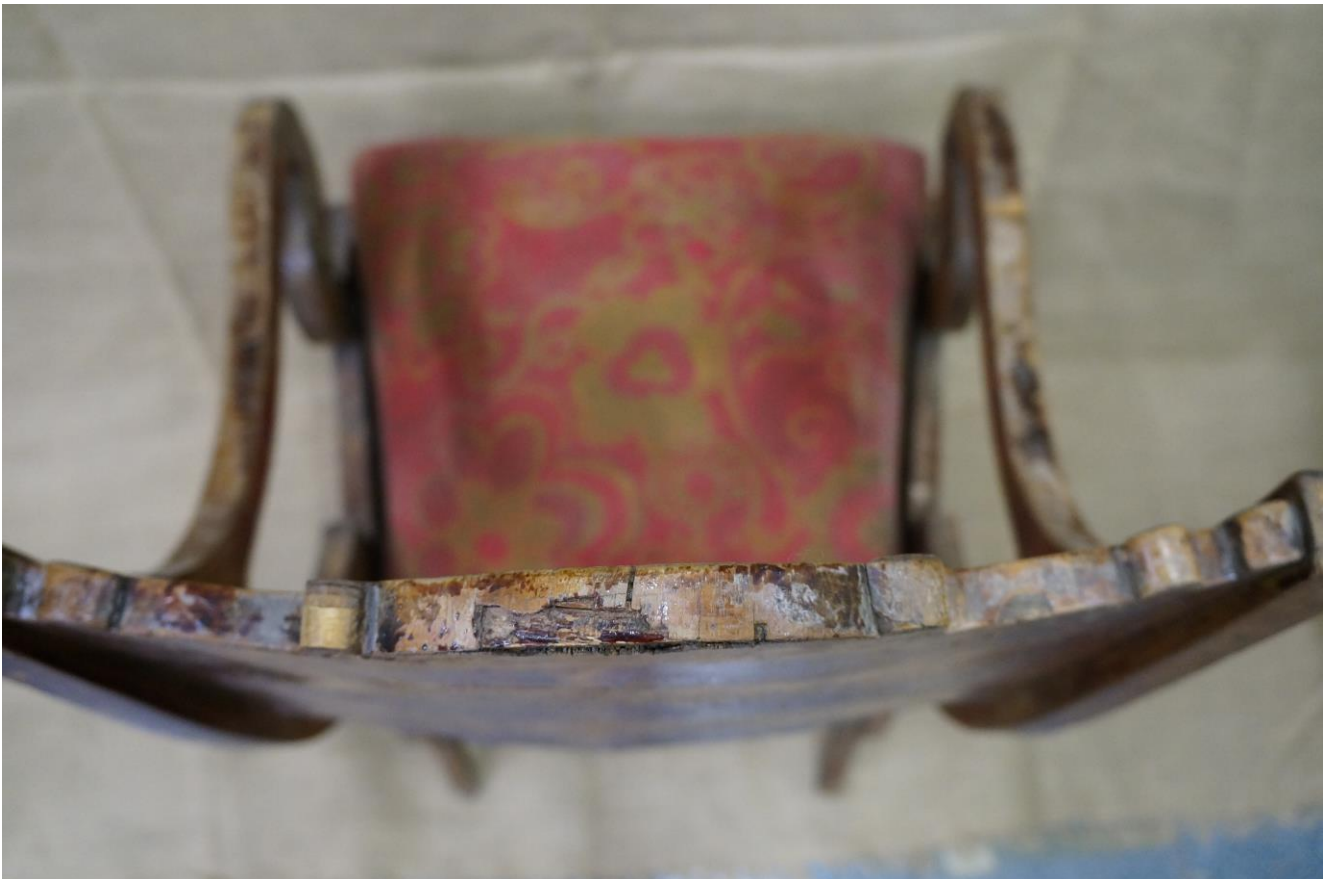
Фото №11. Кромка щитка спинки. Утраты фанеровки.
