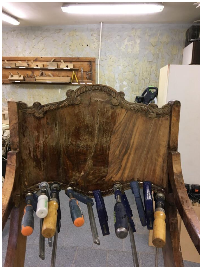
Фото №47. Щиток спинки. Подклейка накладной резьбы.
