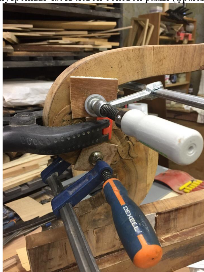
Фото№56. Внутренняя часть левого локотника. Восполнение утраченной резьбы.
