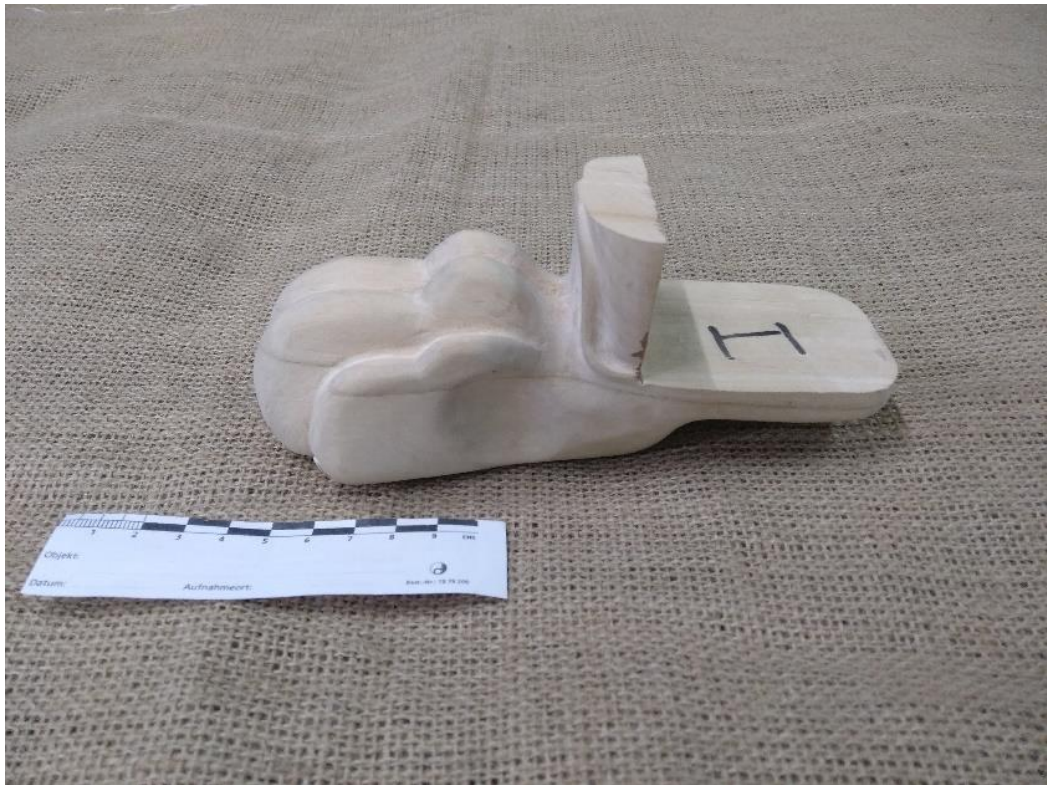
Фото №39. Резьба ножек в форме лап. Завершающий этап.
