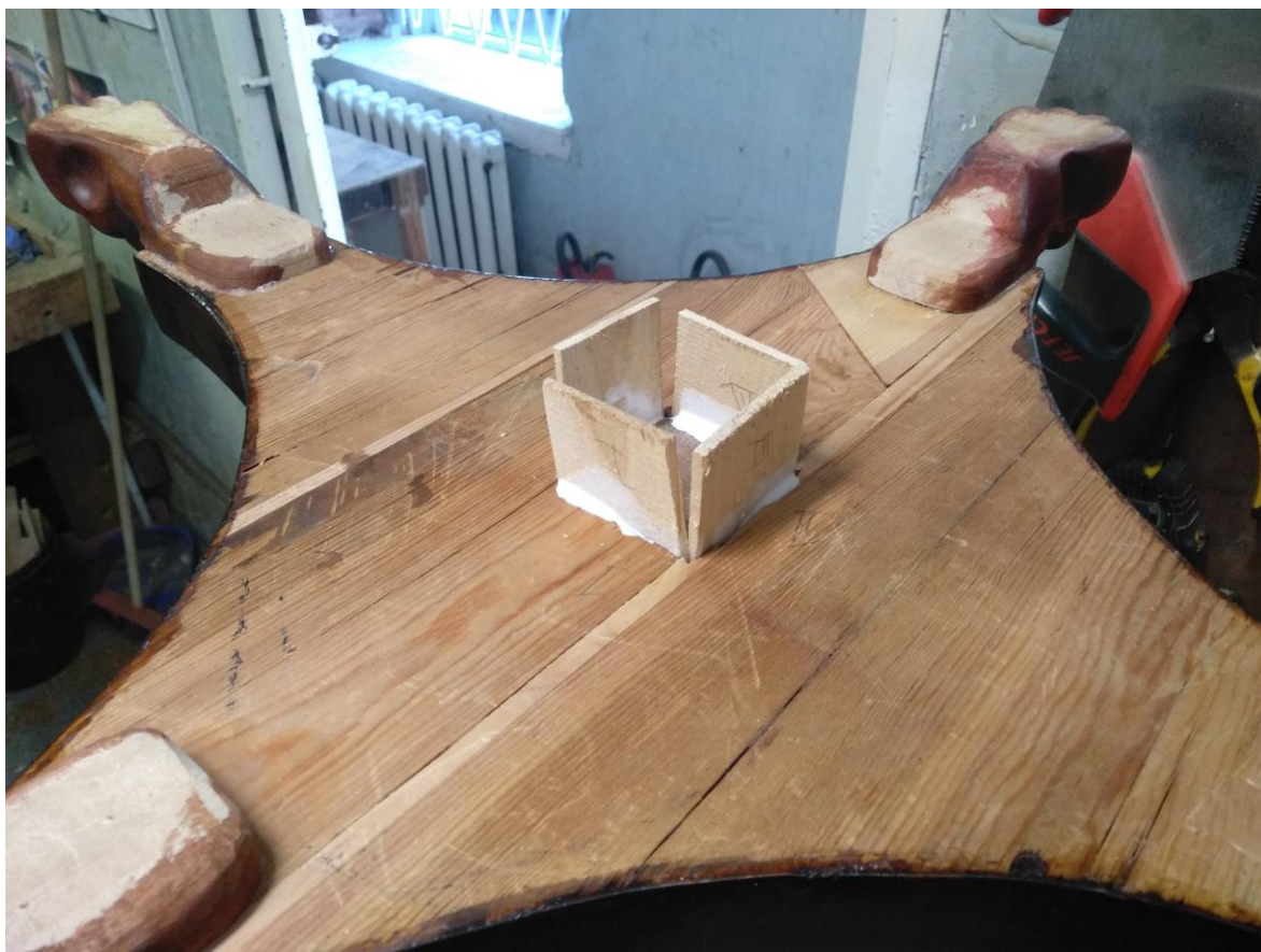
Фото №48. Установка центральной ножки в подстолье на клинья
