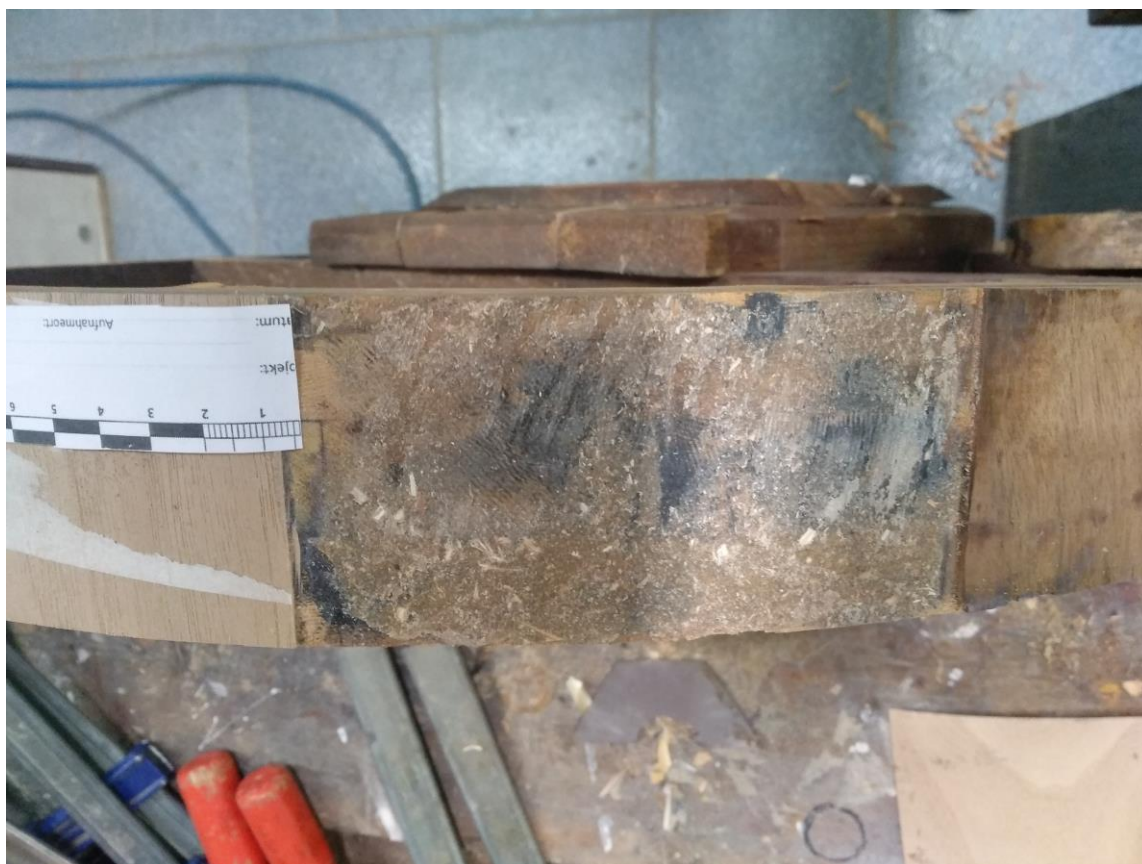
Фото №28. Подготовка поверхности на царговом поясе для фанеровки
