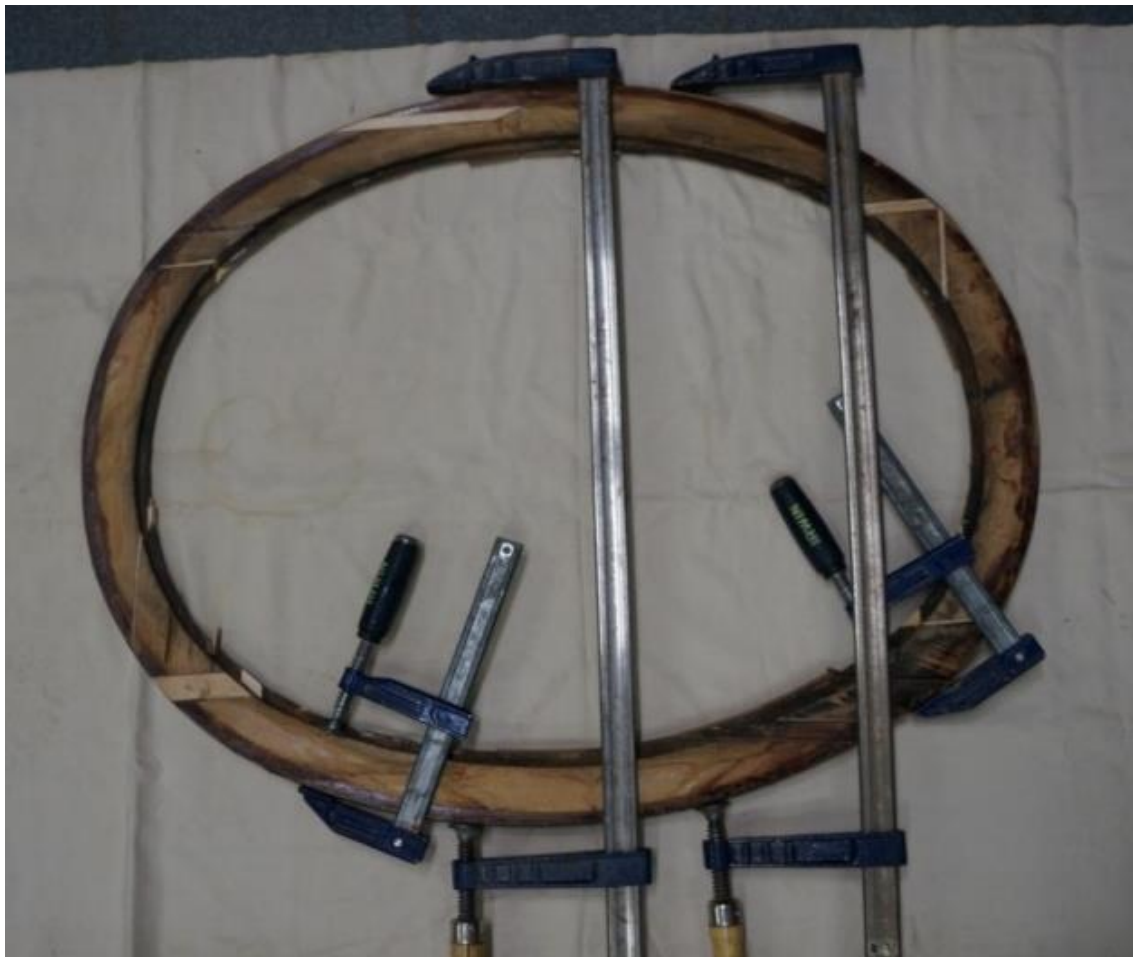
Фото №11. Переклейка обноски каменной столешницы.
