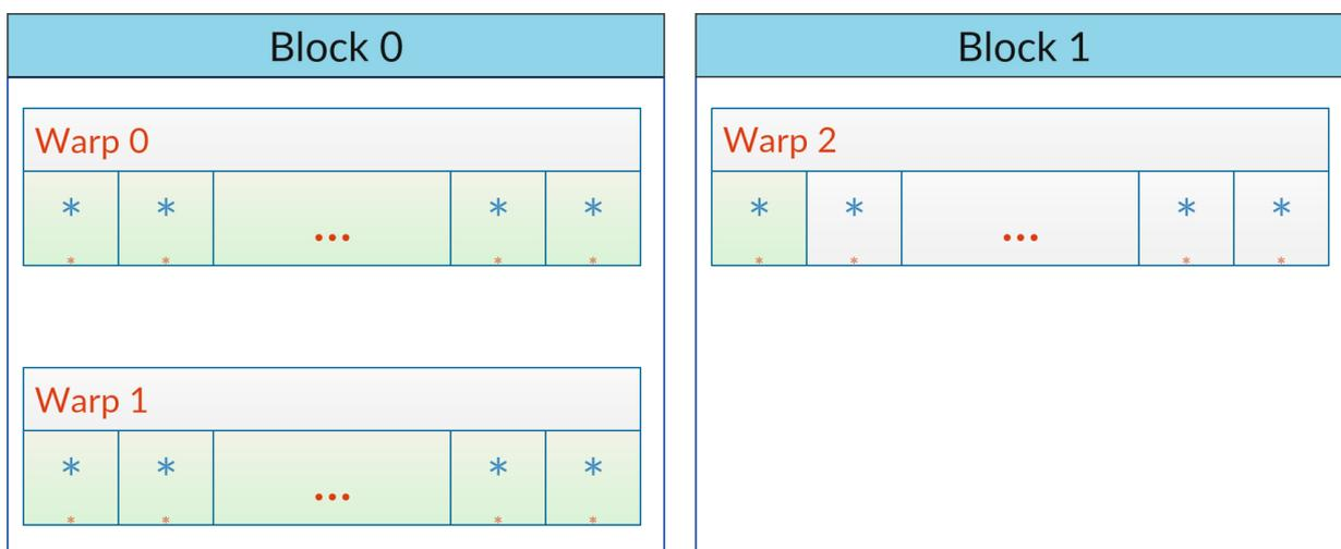
**Рис. 6:** Распределение потоков по группам warp и блокам. Размер блока  $(32,2,1)$ . Количество фактически используемых рабочих потоков — 65. Количество зарезервированных потоков — 96.
