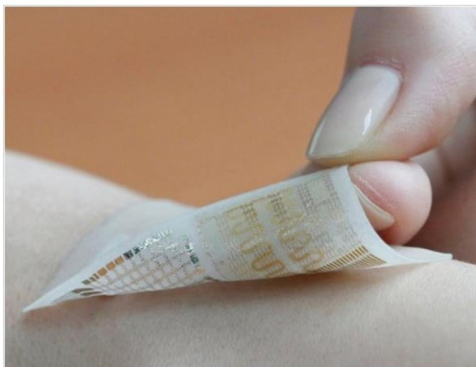
Неинвазивный глюкометр компании SugarBEAT позволяет контролировать уровень глюкозы в крови, не прибегая к механическим нарушениям кожных покровов. Нательный датчик пропускает незаметный электрический ток по коже, вытягивая молекулы глюкозы во внутреннюю камеру пластыря для измерения. Выход девайса на рынок ожидается во второй половине 2019 г.
