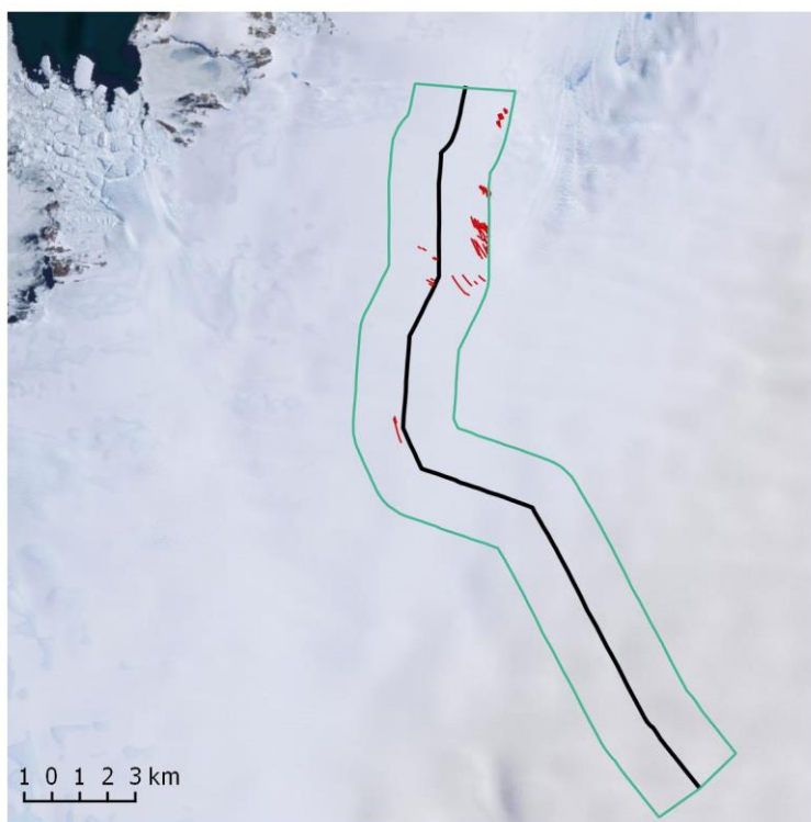
Рисунок 22. Схема анализируемого участка (бирюзовым цветом выделена область съемки, черным – ось санно-гусеничного похода, красным – ледниковые трещины)
